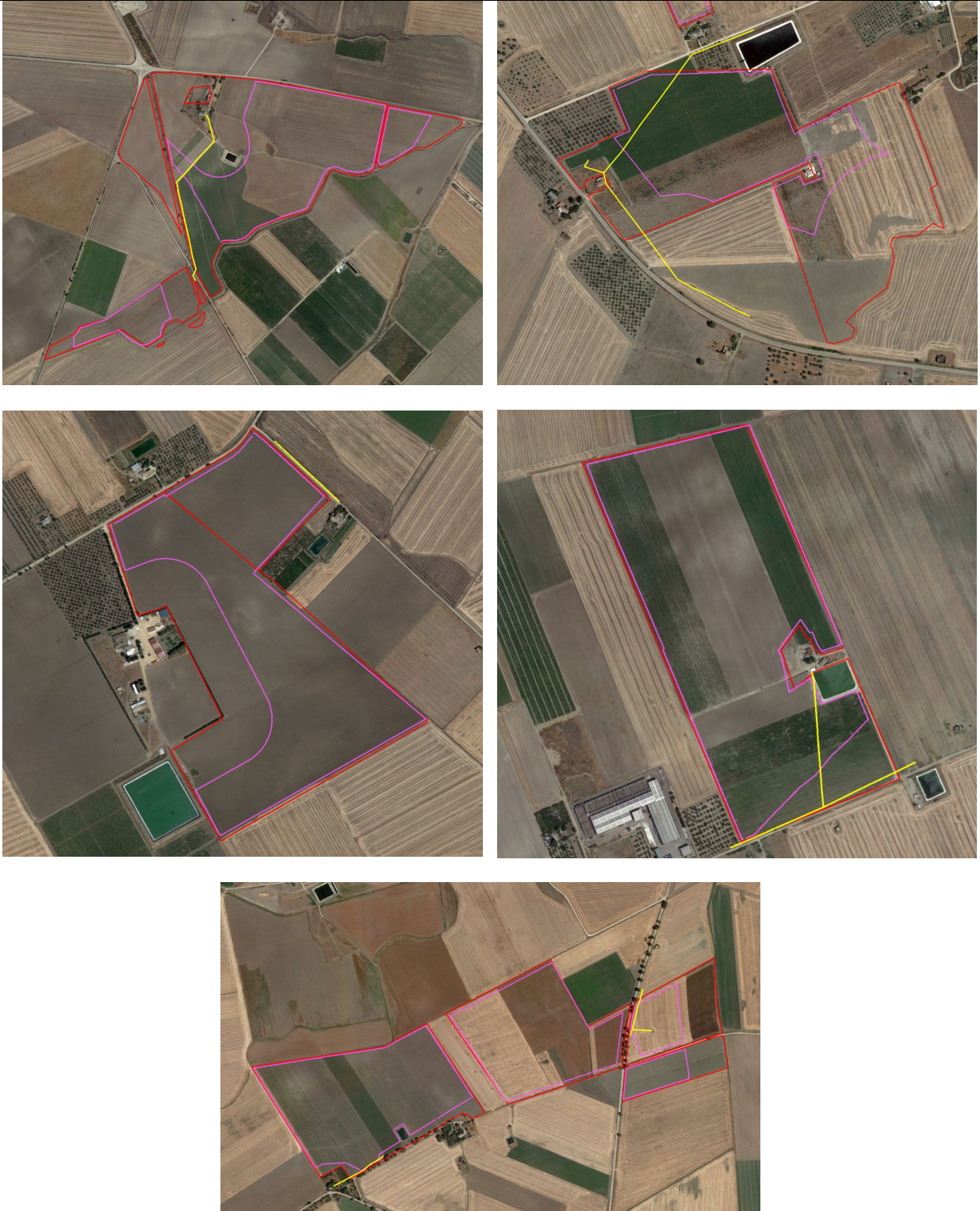
Figura 44 – Linee elettriche BT nei pressi dell’area di impianto (in giallo). In rosso l’area di impianto; in magenta l’area utile che verrà occupata dal layout di impianto.
