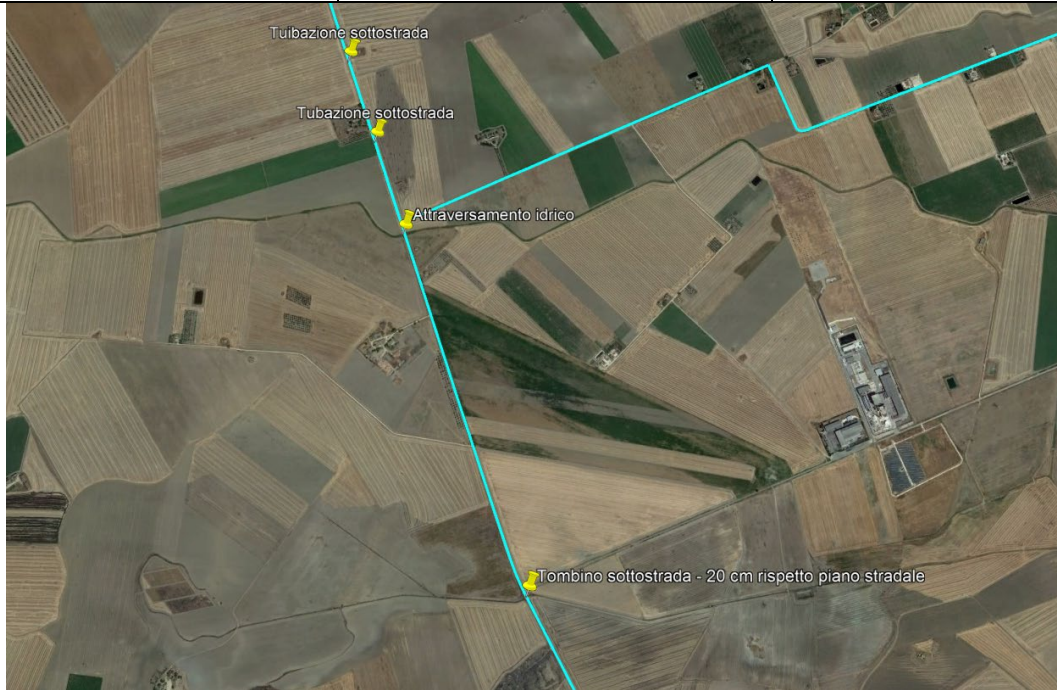
Figura 50: Inquadramento di dettaglio sul cavidotto MT con interferenze (indicatori in giallo). In ciano, il cavidotto MT.
