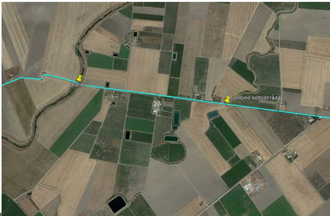
Figura 53: Inquadramento di dettaglio su cavidotto MT (in ciano) con interferenze (indicatori in giallo).
