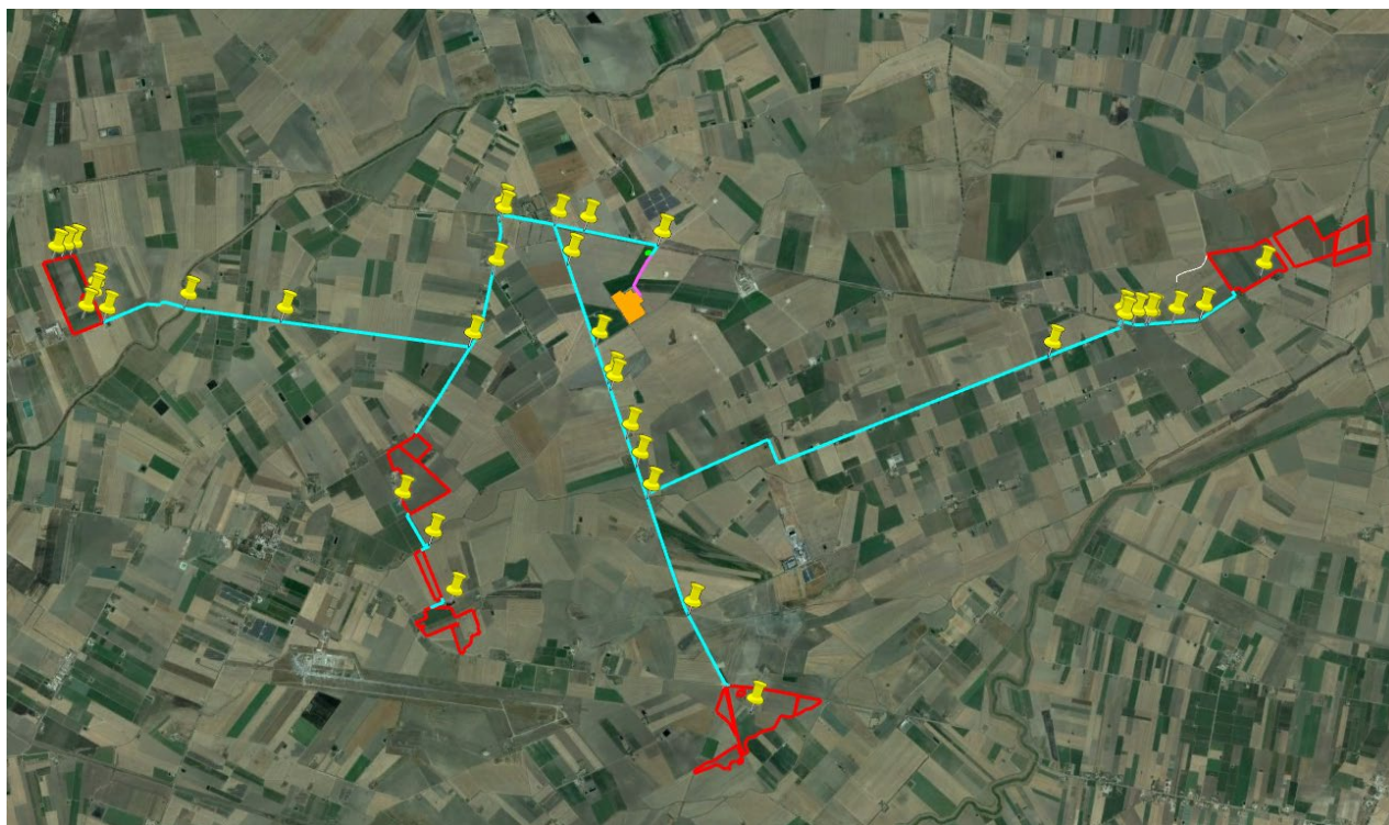
Figura 47: Inquadramento dell'impianto agrivoltaico "Foggia-Manfredonia" e interferenze (indicatori in giallo). In rosso, le aree di impianto. In ciano, il cavidotto MT. In magenta, il cavidotto AT. In verde, la Sottostazione Utente 150/30 kV. In arancione, la Stazione Elettrica Manfredonia 380/150 kV
