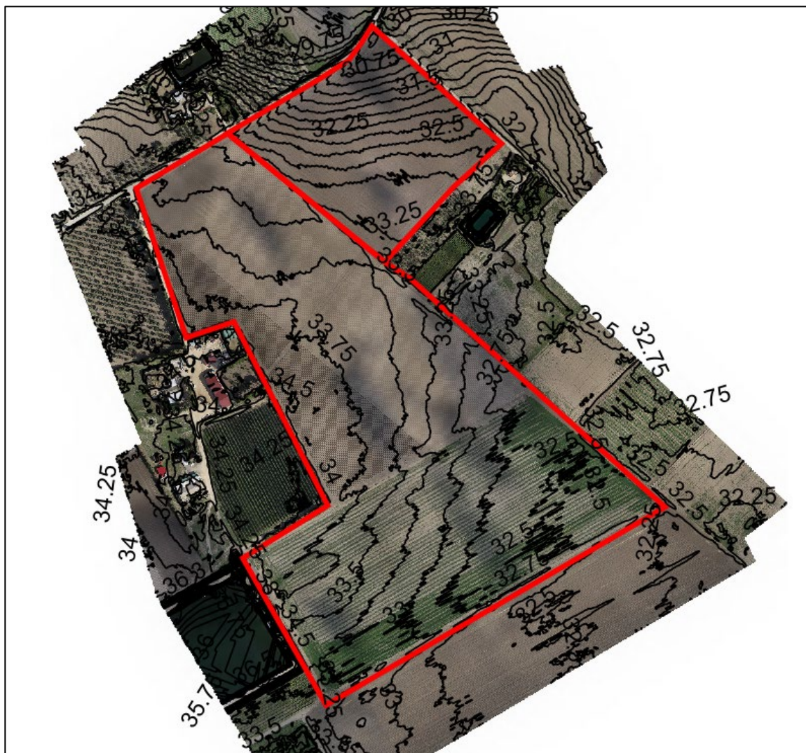
Figura 20 - Inquadramento dei limiti del Lotto 4 (in rosso) su ortofoto e curve di livello con risoluzione a 25 cm rilevate in sito nel mese di dicembre 2022. In nero, le curve di livello con risoluzione di 25 cm. In rosso, l'area di impianto - LOTTO 4
