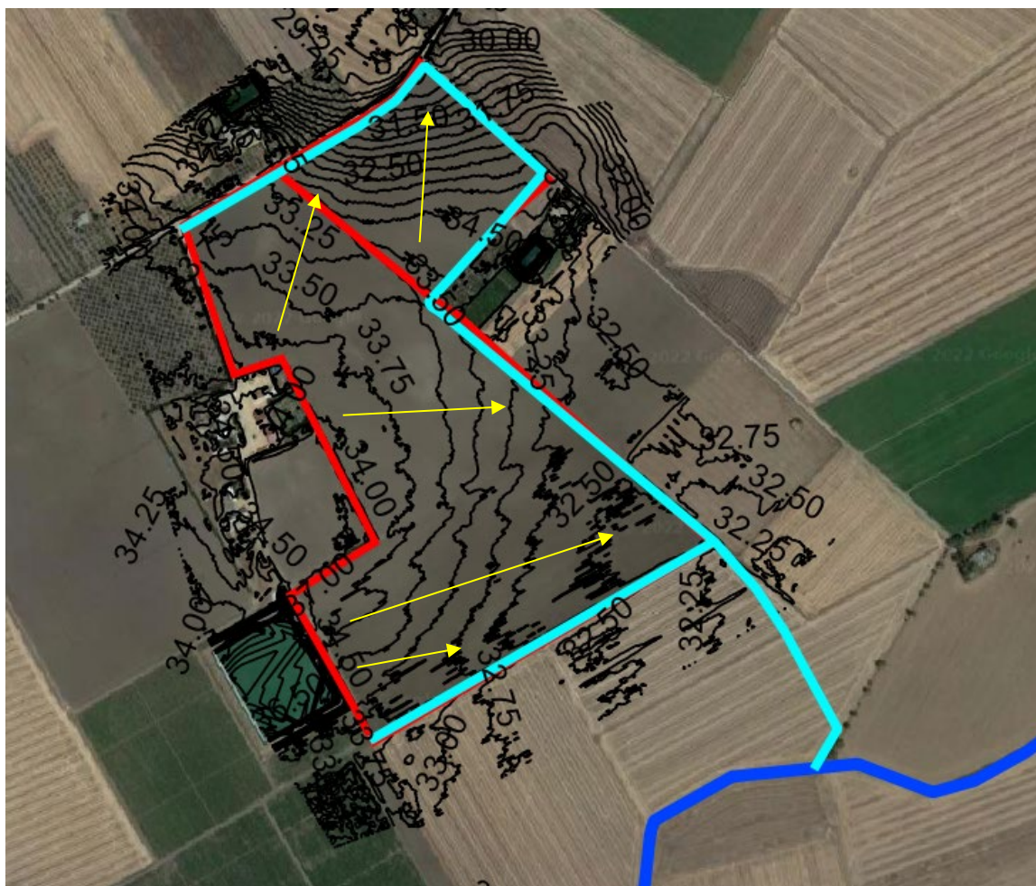
Figura 25 - Inquadramento su ortofoto delle perimetrazioni dei canali di scolo esistenti (in blu) rilevate in sito nel mese di dicembre 2022. In ciano, le perimetrazioni dei canali da realizzare ex-novo. In nero, le curve di livello con risoluzione di 25 cm. In giallo, le direzioni principali di deflusso.
