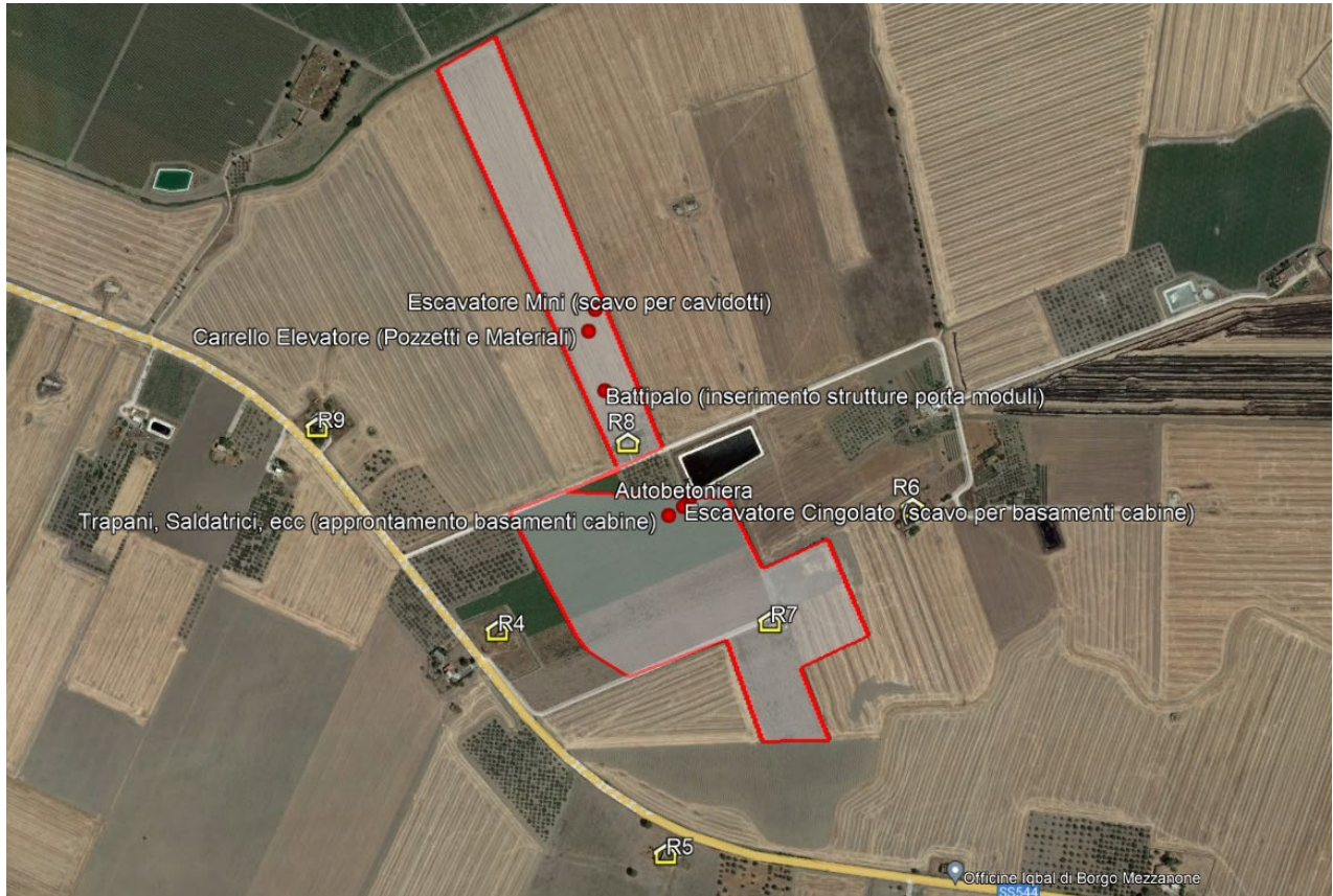
Fig.24: Posizionamento delle sorgenti Lotti 2 e 3: Opere Civili + Montaggio Strutture, Moduli e Cabine
