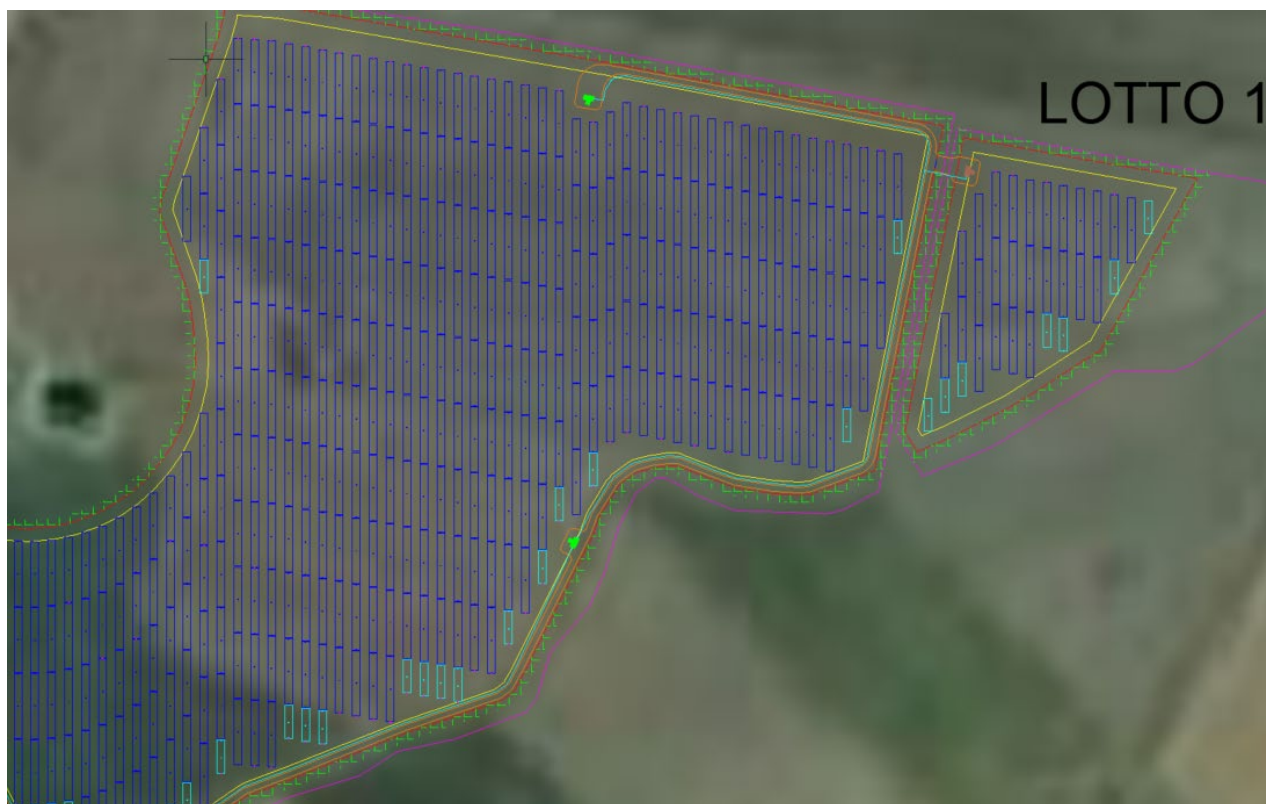
Figura 27 - Dettaglio dei confini del Lotto 1 (in magenta), della recinzione di impianto (rosso) e del buffer di 8 m (in giallo) tra la recinzione e e le strutture di sostegno dei moduli.
