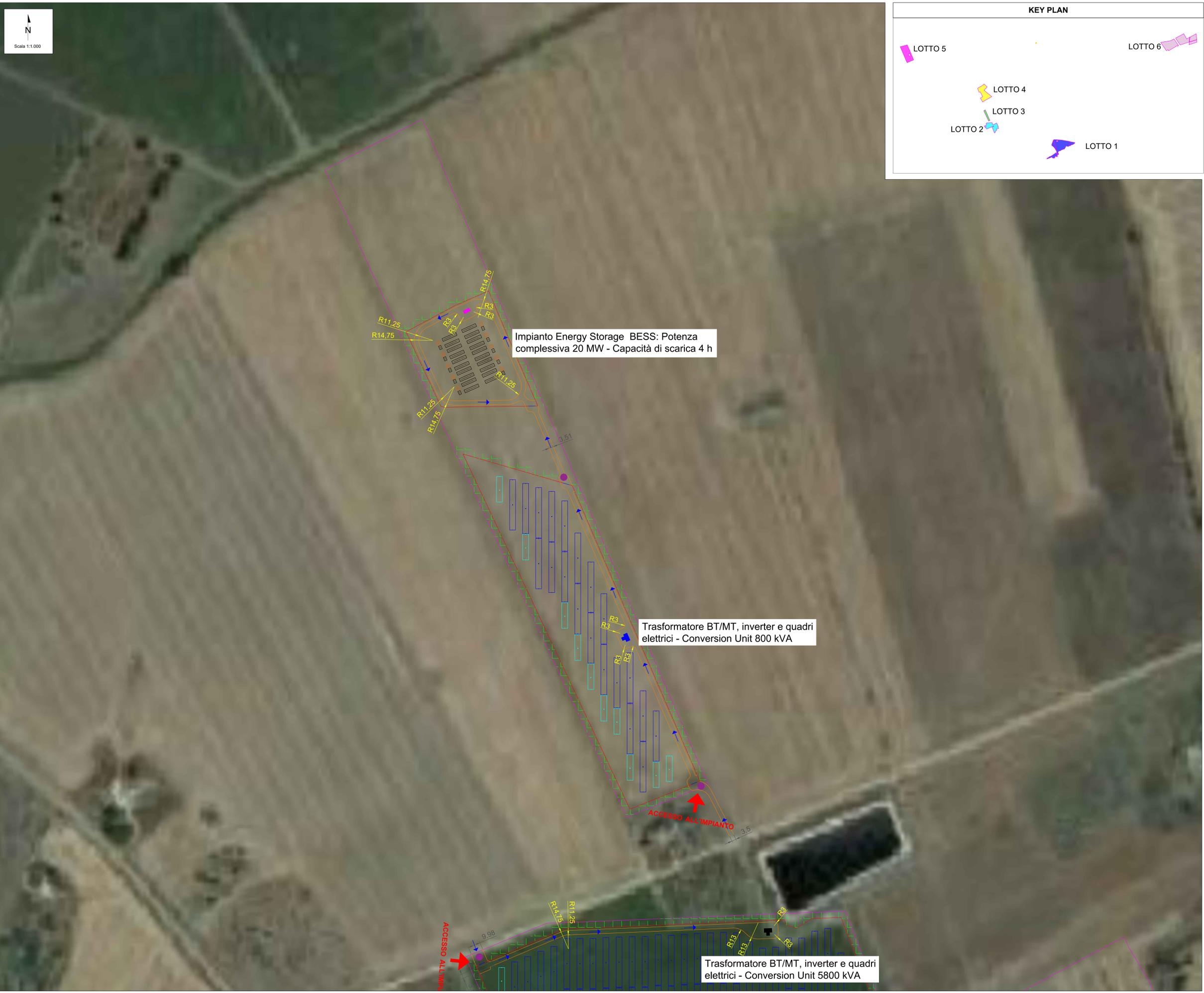
Impianto Energy Storage BESS: Potenza complessiva 20 MW - Capacità di scarica 4 h
