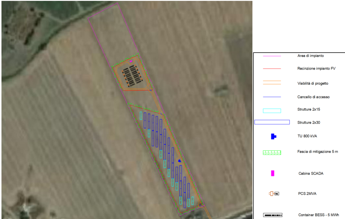
Figura 10 – Sovrapposizione su ortofoto del layout di impianto - Lotto 3 ed area BESS
