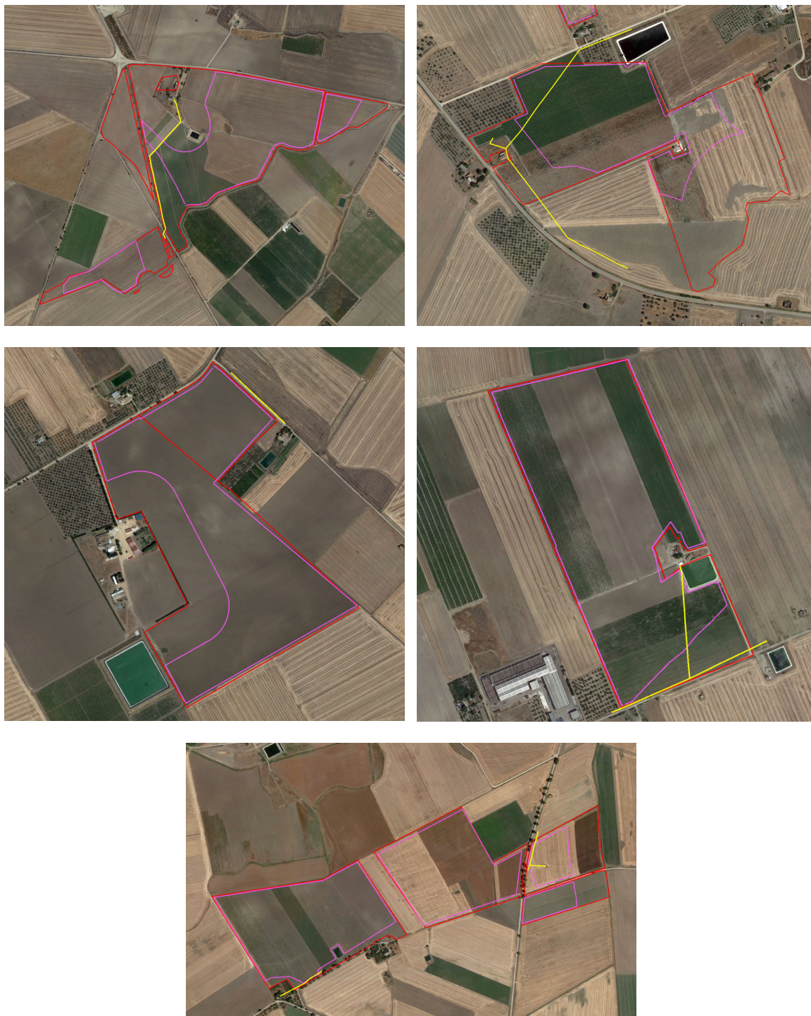
Figura 5 – Linee elettriche BT nei pressi dell'area di impianto (in giallo). In rosso l'area di impianto; in magenta l'area utile che verrà occupata dal layout di impianto.
