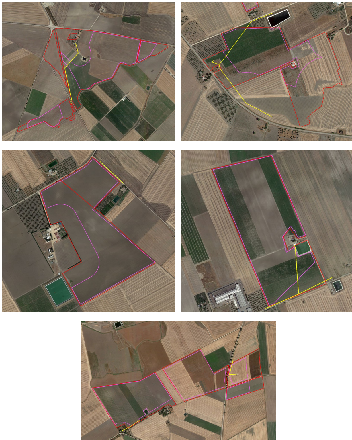
Figura 5 – Linee elettriche BT nei pressi dell'area di impianto (in giallo). In rosso l'area di impianto; in magenta l'area utile che verrà occupata dal layout di impianto.
