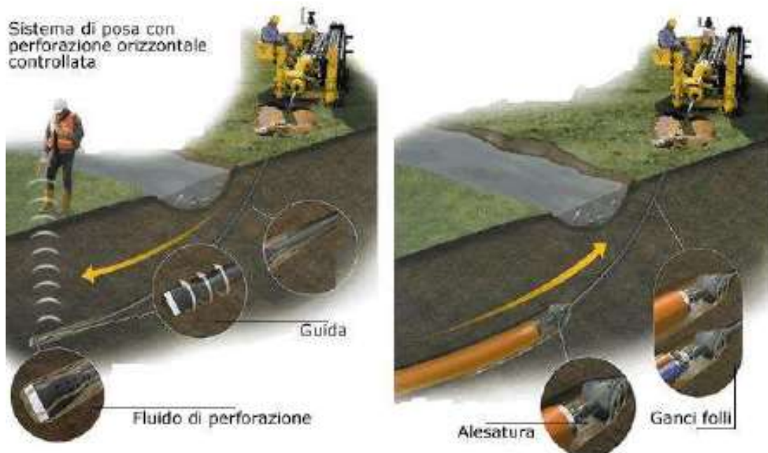
Posa in opera tubazione con trivellazione teleguidata
