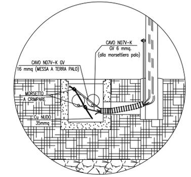
Sezione scavo di illuminazione perimetrale e dati
