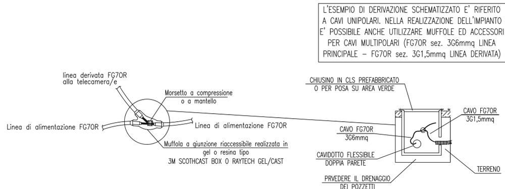
PARTICOLARI DERIVAZIONE CAVI ILLUMINAZIONE DENTRO POZZETTI (non in scala)
