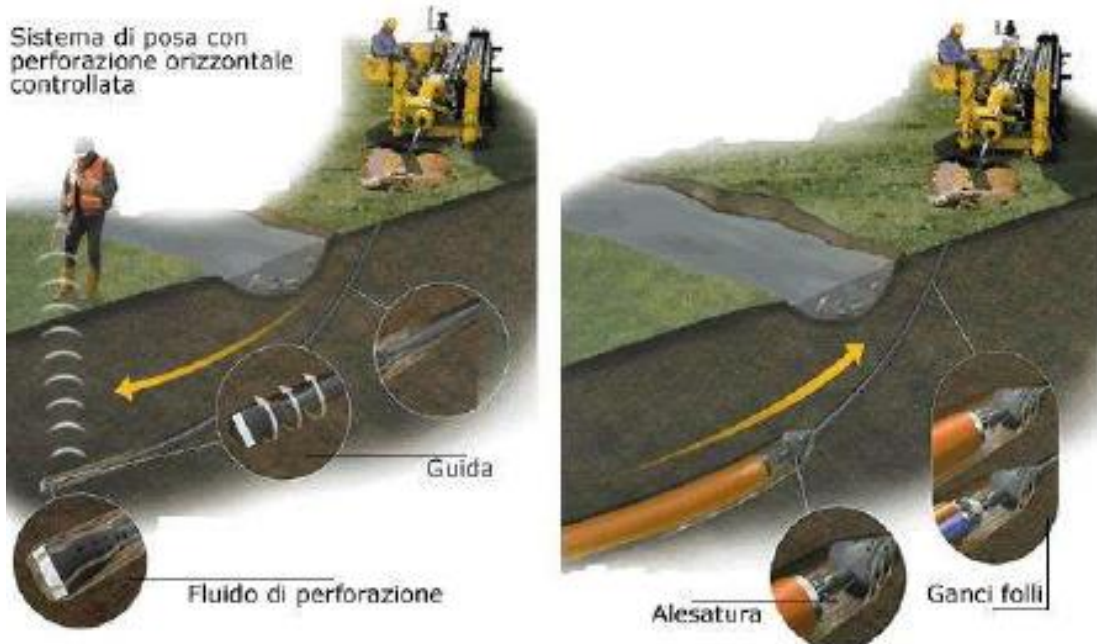
Posa in opera tubazione con trivellazione teleguidata
