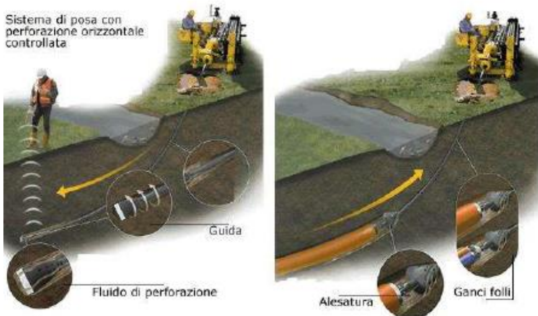
Posa in opera tubazione con trivellazione teleguidata
