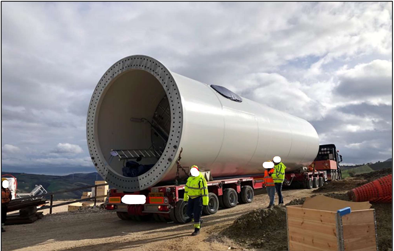
Figura 2.2: Mezzo speciale trasporto componenti WTG
