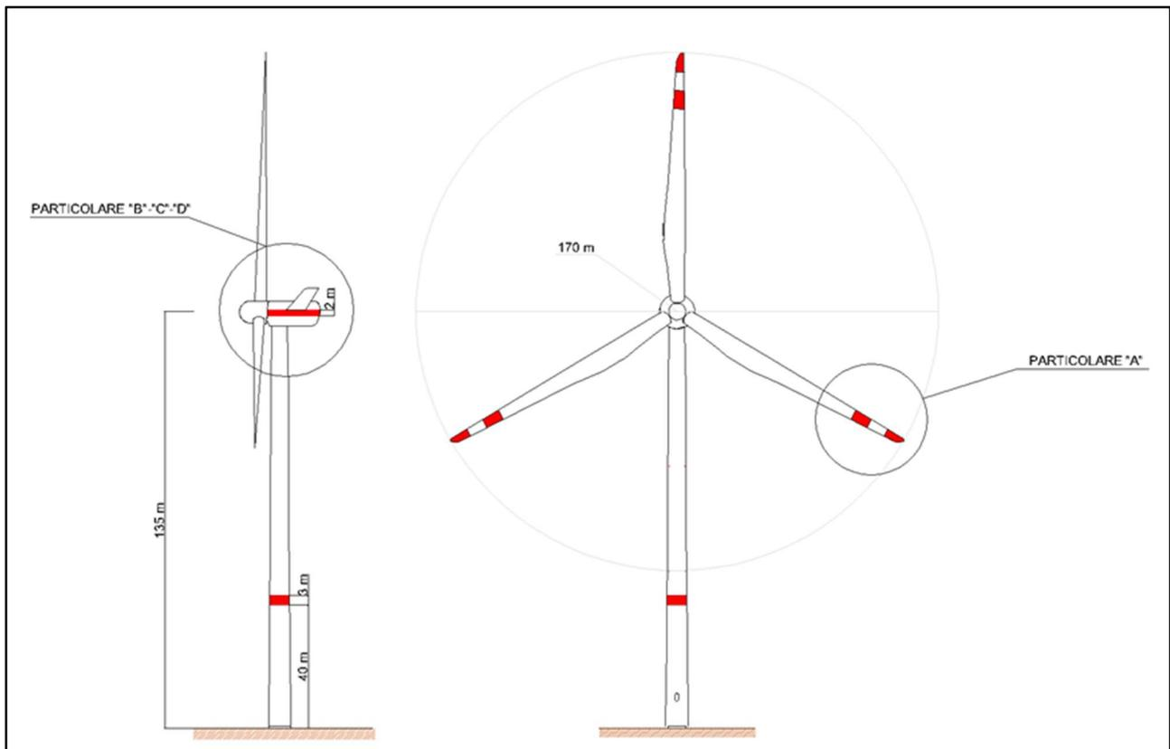
**Figura 4.1:** Profilo aerogeneratore SG170 – 6.0 MW
