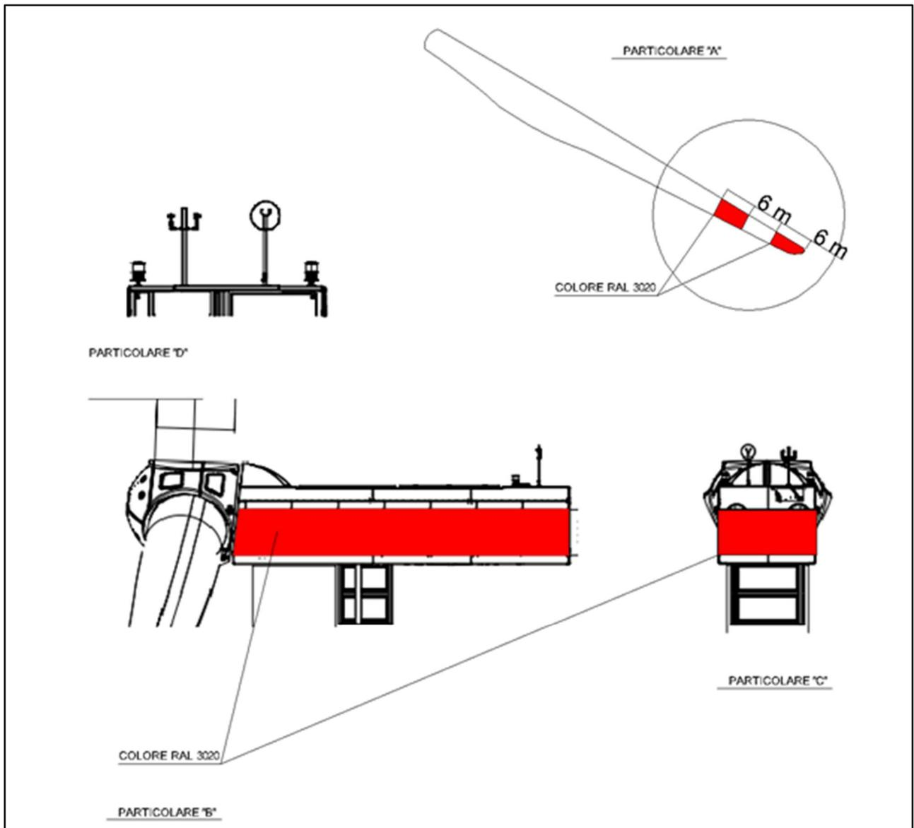
Figura 4.2: Particolari aerogeneratore SG170 – 6.0 MW di cui alla Figura 4.1
