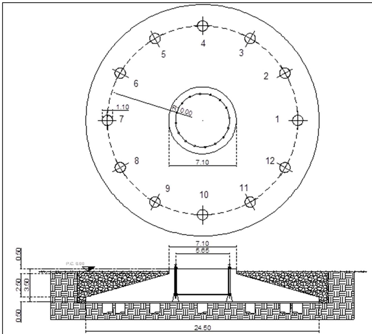
**Figura 5.1:** Dettaglio pianta e sezione fondazione
