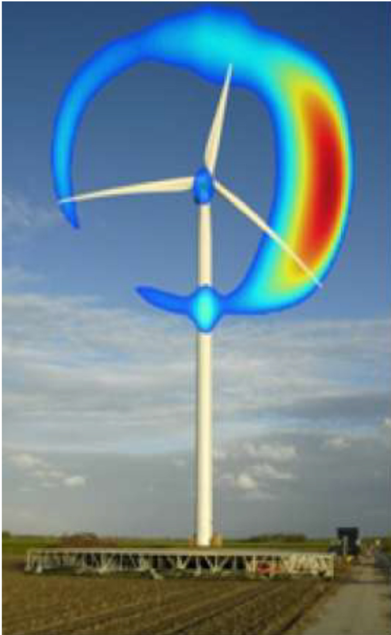
Rumore rilevato con SISTEMA BEAMFORMING
