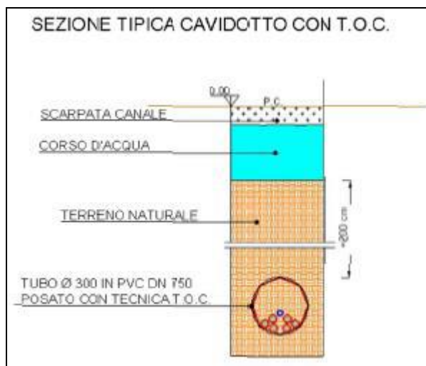
Figura 29. Sezione tipica di attraversamento in TOC.
