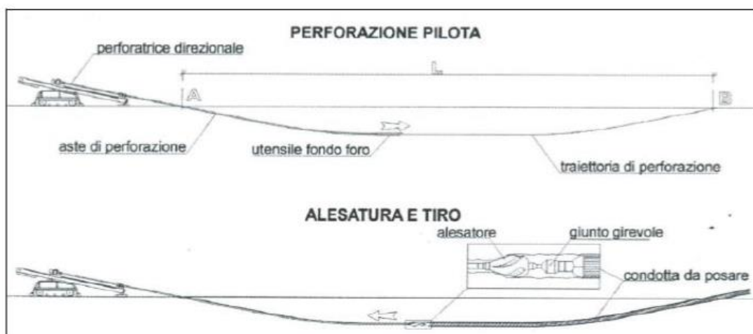
Figura 14: Schematico di trivellazione orizzontale controllata.
