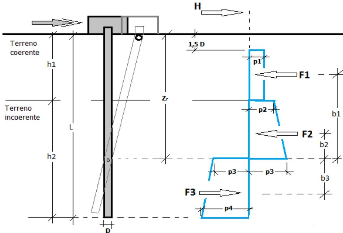
Nella fase di calcolo, si verifica se il meccanismo di rottura del palo, ipotizzato vincolato in testa (rotazione alla testa impedita) sia di:
