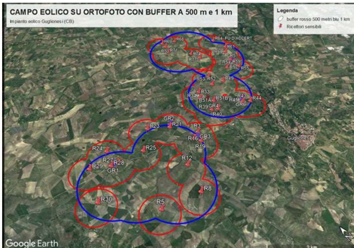
Figura 14 Ortofoto Recettori e turbine entro gli areali di 500 e 1000 metri
