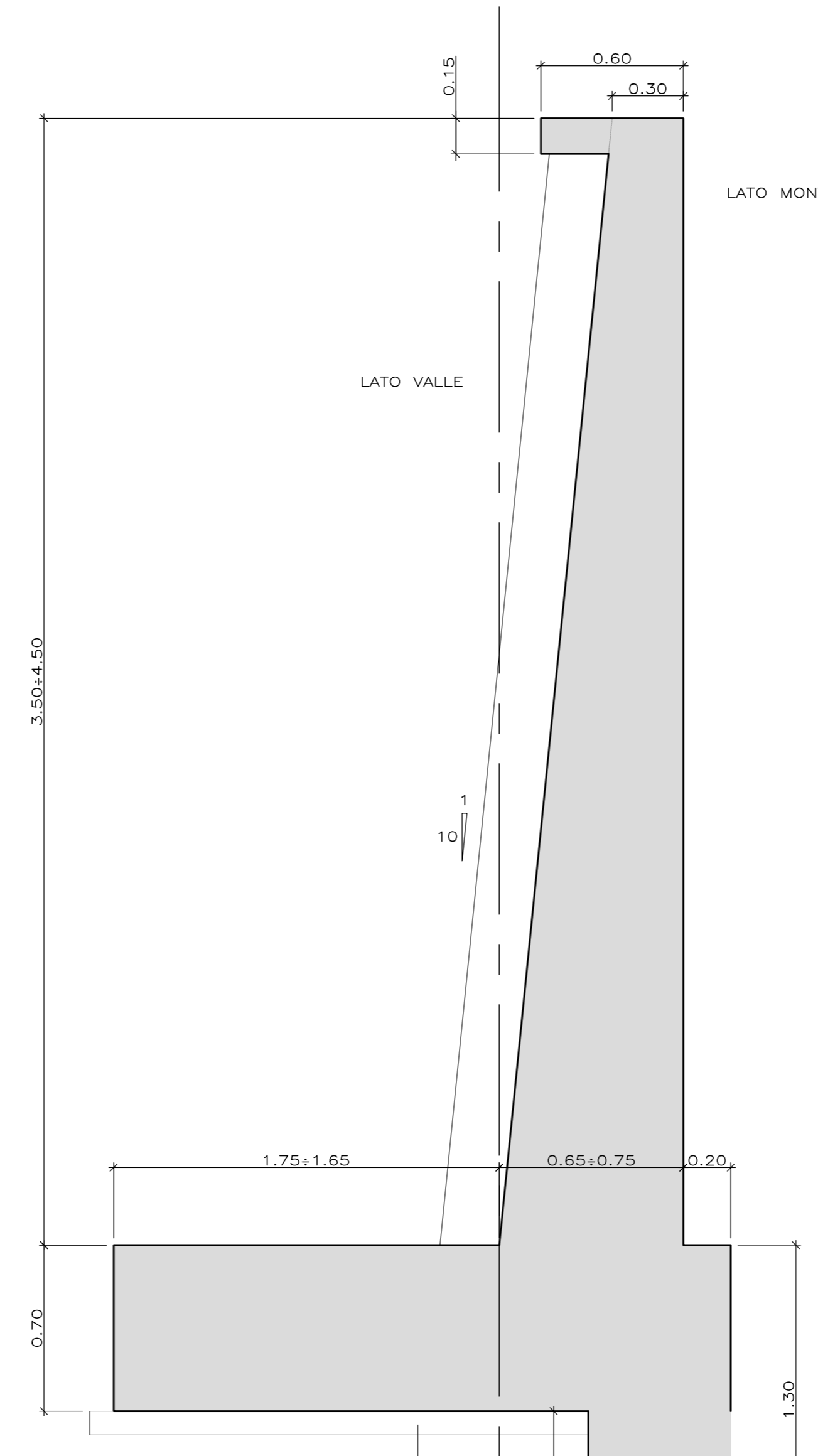
CONCI 8-9-10-11 MURO TIPO 2 – CARPENTERIA Scala 1:20
