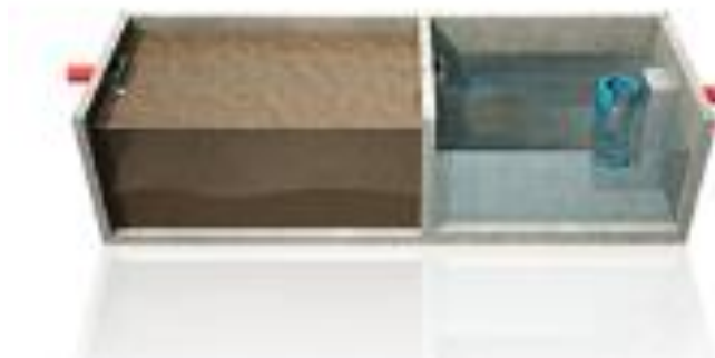
Figura 5.2 - Schema vasca di prima pioggia in continuo.
