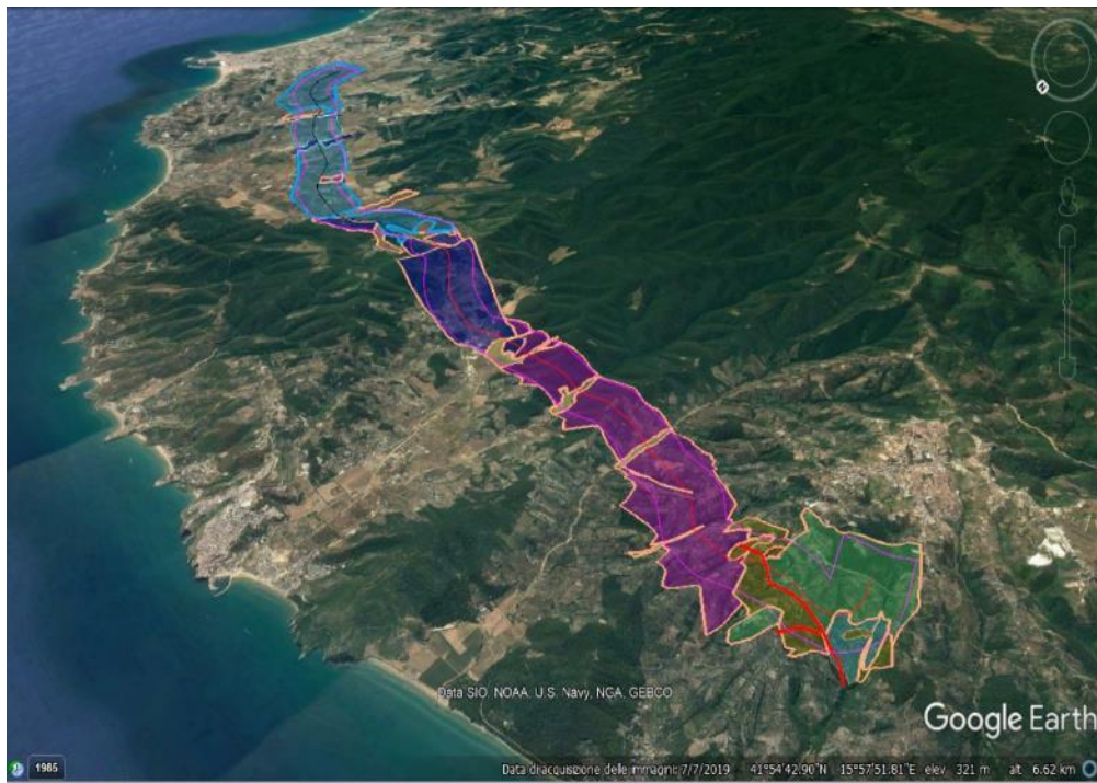
Figura 2-17: Andamento dell'asse viario lungo i versanti a diverso comportamento sulla base della litologia affiorante e della differente morfogenesi, controllata sempre da fattori geolitologici e geostrutturali; l'asse stradale di progetto si sviluppa in 3 ambiti differenti: l'area di svincolo di Vico nei calcari di Monte Sant'Angelo, privi di corsi d'acqua ed in ambiente carsico, buona parte della tratta 1b sui calcari Maiolica e sui calcari tipo Scaglia, incisi dal reticolo idrografico con passaggi in galleria nei calcari ed attraversamento di corsi d'acqua, colmi di detrito, su viadotto, infine l'ultimo settore, della Tratta 2, dove si apre la piana alluvionale e, al contrario, si osservano solo due dorsali in calcare tipo Scaglia che emergono dal materasso fluviale-detritico.
