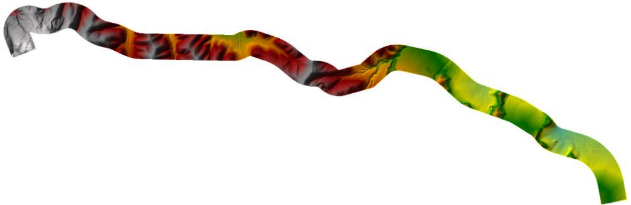
Figura 2-23– Modello DEM utilizzato per la ricostruzione della geometria dell’alveo.
