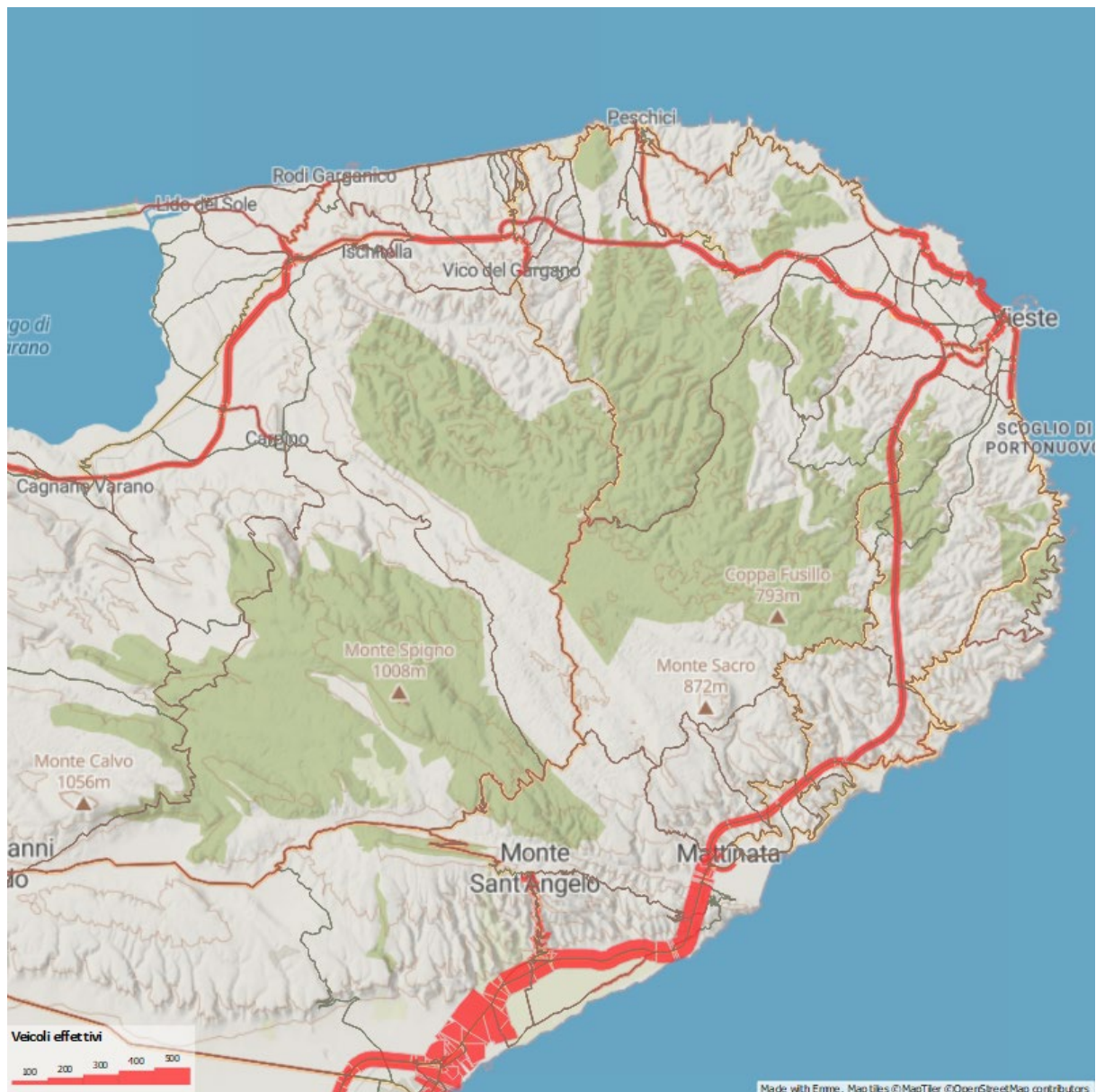
Figura 3.17: Grafo caricato con i flussi veicolari nell’ora di simulazione (2030). Scenario di progetto dell’itinerario completo Vico del Gargano – Mattinata
