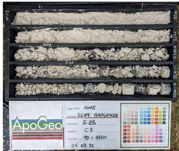
Figura 2 - A sx lo Scoglio di Pizzomunno, presso Vieste, che simboleggia la tenacità della formazione del calcare tipo Scaglia; a dx un esempio della difficoltà di carotaggio nella Scaglia stessa, con il materiale che si frantuma e si disgrega, alterandosi completamente, con il carotiere semplice; le carote leggermente più integre, ma con perdita di buona parte del prelievo, usando il doppio carotiere.
