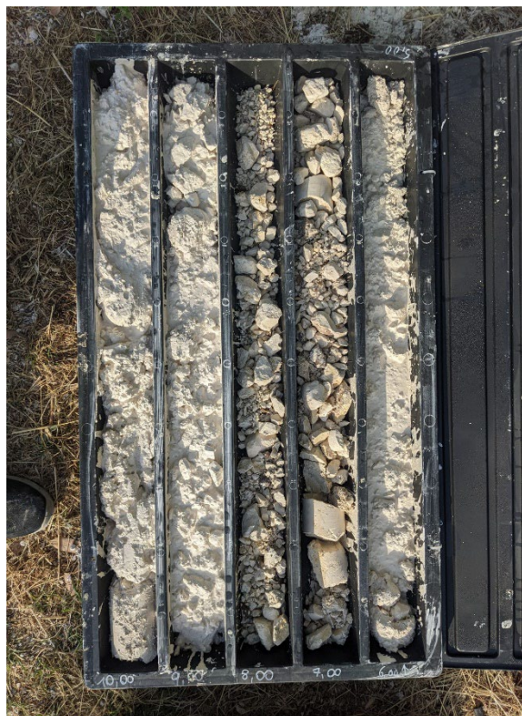
Figura 2 - cassetta di sondaggio con carotaggio in Calcare tipo Scaglia: si evidenzia lo stato del materiale, dove le dimensioni degli spezzoni non consentono un adeguato prelievo di elementi utili per prove ELL nè RQD significativo
