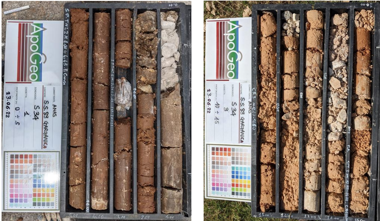
Figura 6.31: Unità geotecnica a – S34-PZ 0-5 m(sinistra) e S34-PZ 10-15 m (destra).
