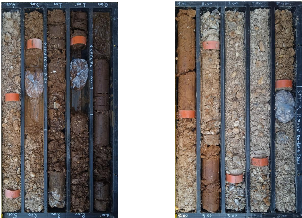
Figura 6.30: Unità geotecnica a – S29-PZ 0-5 m(sinistra) e S29-PZ 10-15 m (destra).
