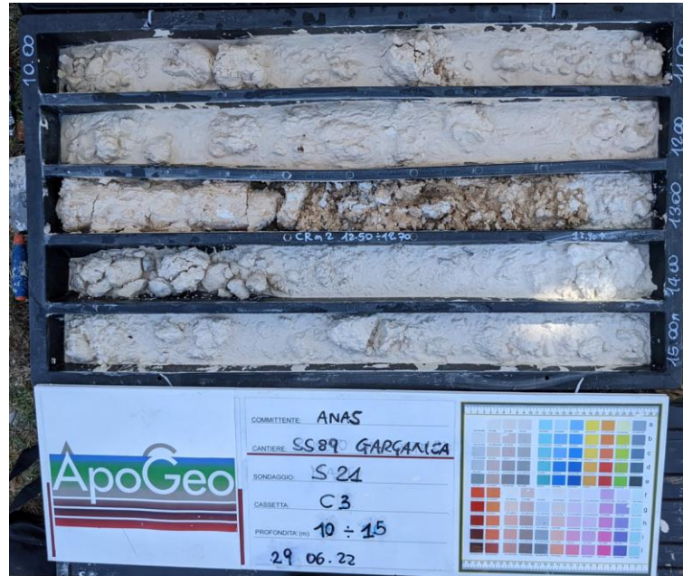
Figura 6.18: Unità geotecnica FUC – S21-PZ.
