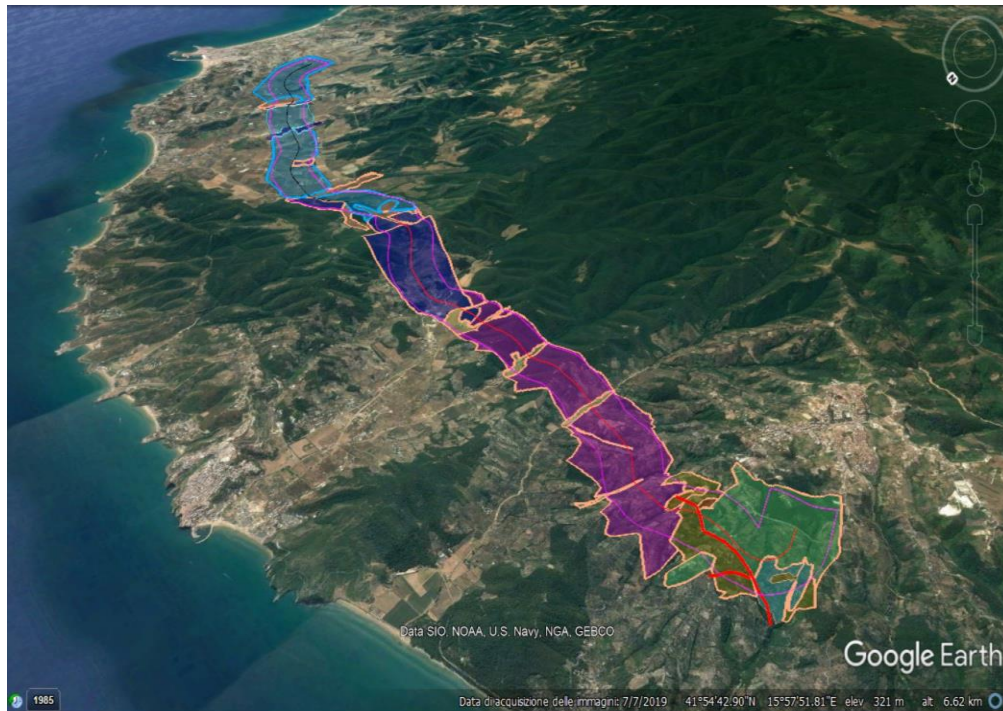
Figura 5 - Andamento dell'asse viario lungo i versanti a diverso comportamento sulla base della litologia affiorante e della differente morfogenesi, controllata sempre da fattori geolitologici e geostrutturali; l'asse stradale di progetto si sviluppa in 3 ambiti differenti: l'area di svincolo di Vico nei calcari di Monte Sant'Angelo, privi di corsi d'acqua ed in ambiente carsico, buona parte della tratta 1b sui calcari Maiolica e sui calcari tipo Scaglia, incisi dal reticolo idrografico con passaggi in galleria nei calcari ed attraversamento di corsi d'acqua, colmi di detrito, su viadotto, infine l'ultimo settore, della Tratta 2, dove si apre la piana alluvionale e, al contrario, si osservano solo due dorsali in calcare tipo Scaglia che emergono dal materasso fluviale-detritico (fonte: Relazione geologica del PFTE).
