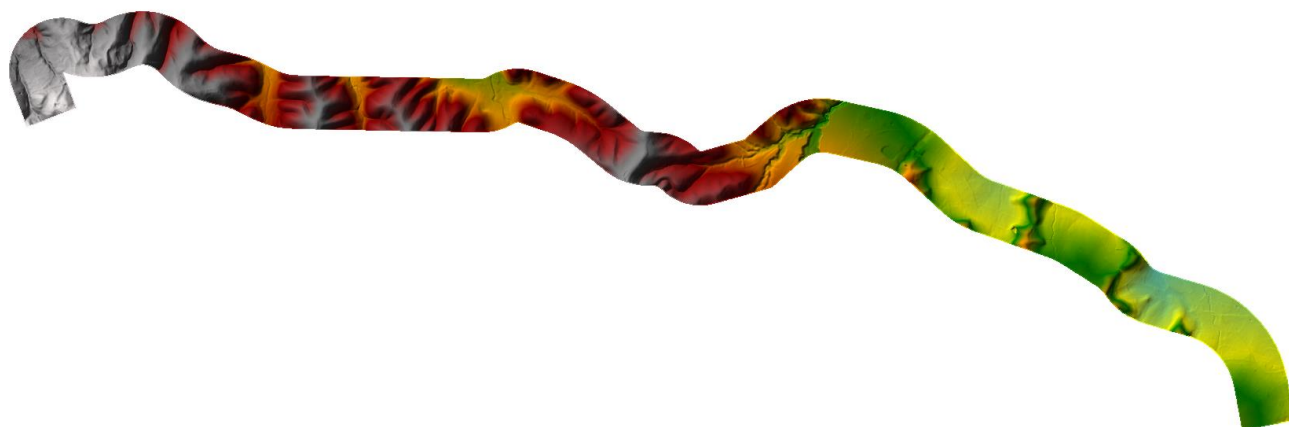
Figura 23– Modello DTM utilizzato per la ricostruzione della geometria dell’alveo.
