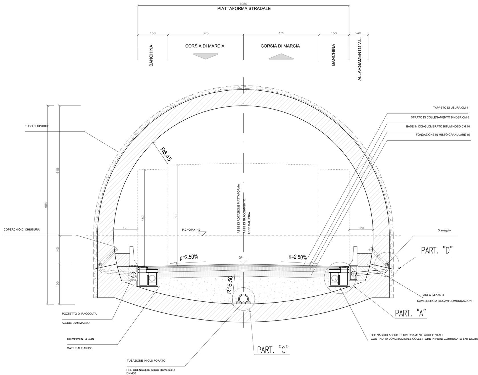
COLLETTORE DI DRENAGGIO DELL'ARCO ROVESCIO - Part. C
