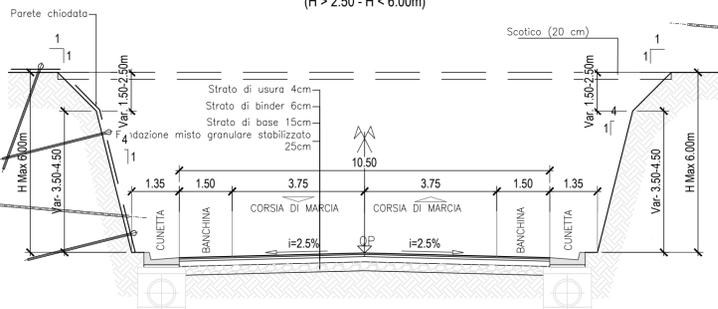
SEZIONE TIPO IN RILEVATO
