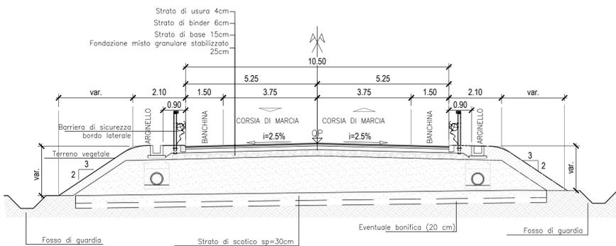
SEZIONE TIPO IN RILEVATO
