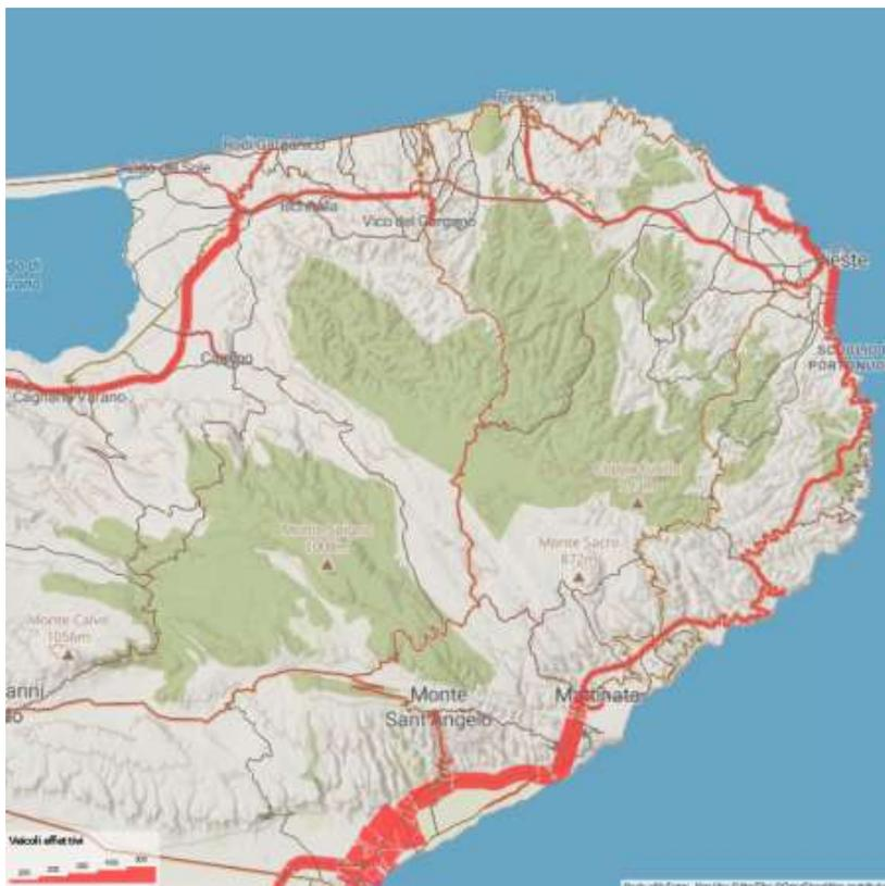
Figura 4-21. Grafo caricato con i flussi veicolari nell'ora di simulazione (2030). Scenario di progetto limitato all'itinerario Vico del Gargano - Vieste.
