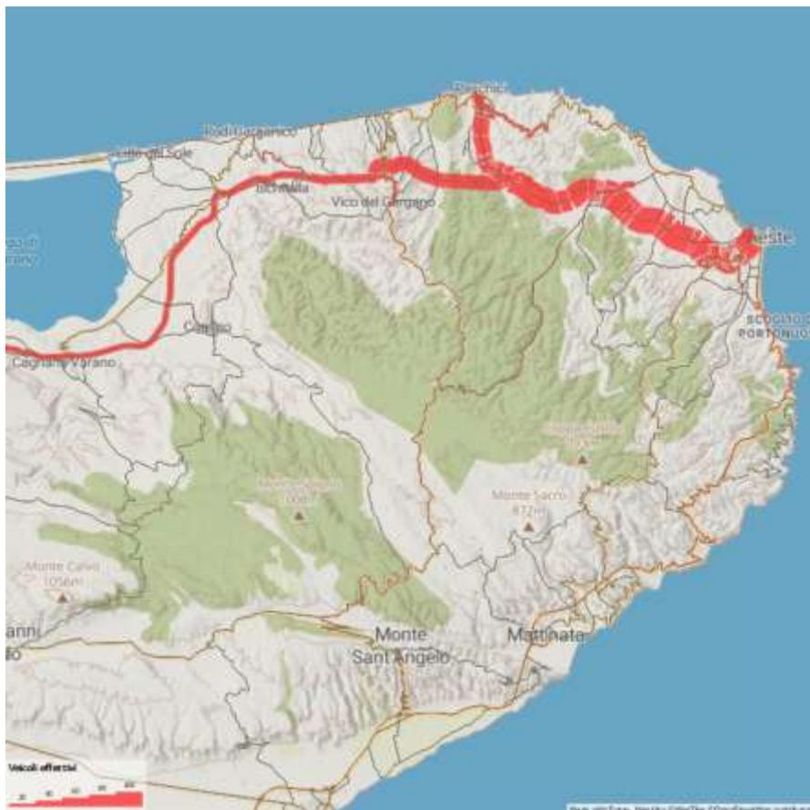
Figura 4-22. Grafo caricato con i flussi veicolari che utilizzano l'asse di progetto nell'ora di simulazione (2030). Scenario di progetto limitato all'itinerario Vico del Gargano – Vieste
