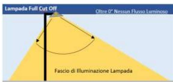
Figura 6-12. Esempio di illuminazione con apparecchiatura “Full Cut Off”
