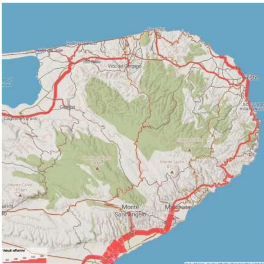
Figura 4-18. Grafo caricato con i flussi veicolari nell'ora di simulazione (2030). Scenario di progetto limitato all'itinerario Vico del Gargano - Vieste.
