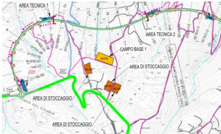
Lungo il tratto in adeguamento del tracciato in progetto si prevede di realizzare una serie di strade complanari che serviranno, al termine dell’opera, come viabilità di ricucitura ma che in una prima fase potranno essere utilizzate sia con la funzione di piste di cantiere ma anche per deviare il traffico in esercizio che in questo modo non verrà mai sospeso e consentendo così di allontanarlo dalle aree di lavoro.
