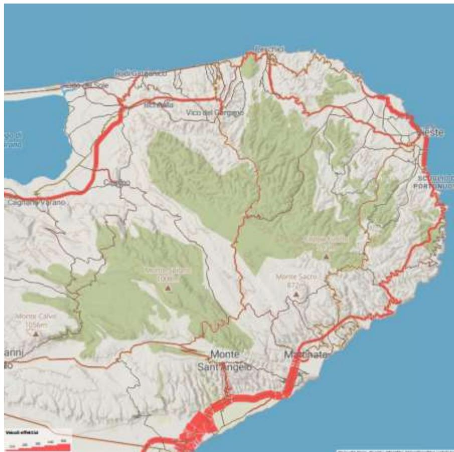
Figura 4-20. Grafo caricato con i flussi veicolari nell'ora di simulazione (2030). Scenario di riferimento
