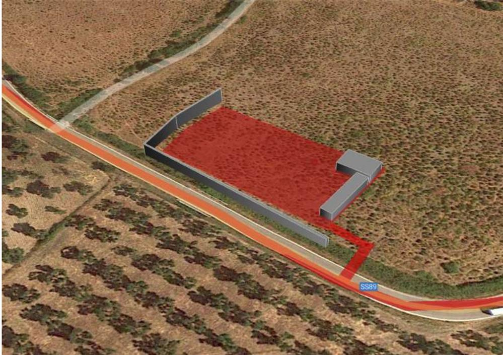
Figura 6-5. Modello geometrico su AERMOD cantiere CO04
