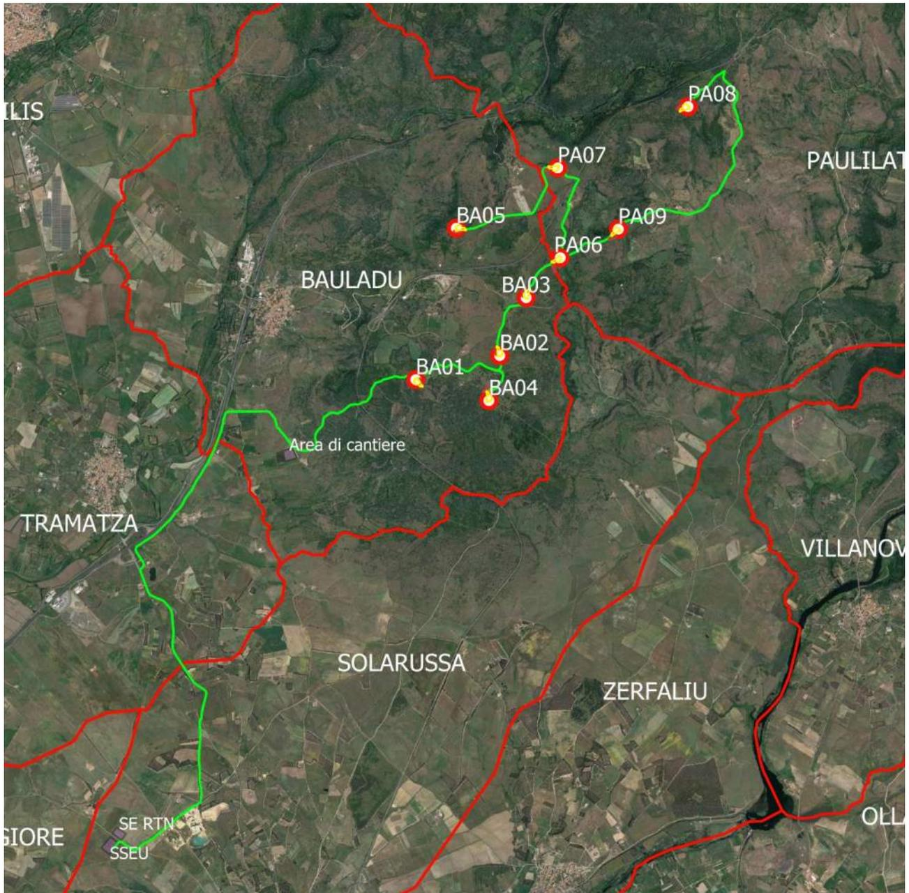
Figura 5 - Postazioni eoliche e sviluppo generale del cavidotto a 30 kV
