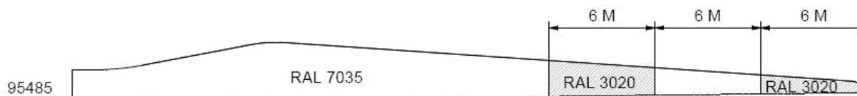
Figura 6.1 – Schema indicativo colorazione pale (la larghezza effettiva delle bande colorate sarà apposta in accordo con quanto specificato in Tabella 6.2)
