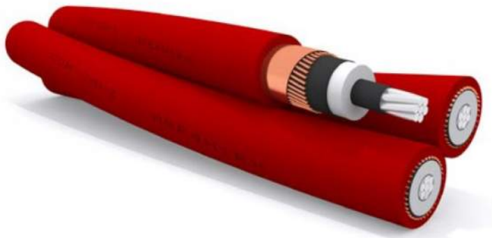
Figura 9.7 - Cavi tripolari del tipo ARE4H1RX - 18/30kV
