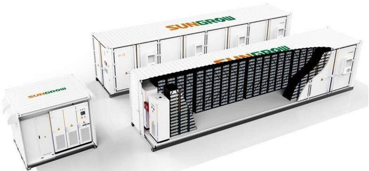
Figura 9.16 – Schema tipico dei componenti di un container batterie (battery block) e relativo PCS L'energia verrà impiegata per la realizzazione dei cicli di carica e scarica nelle batterie in Bassa Tensione e a frequenza pari 50 Hz; nel trasformatore di macchina integrato nel BESS la tensione
