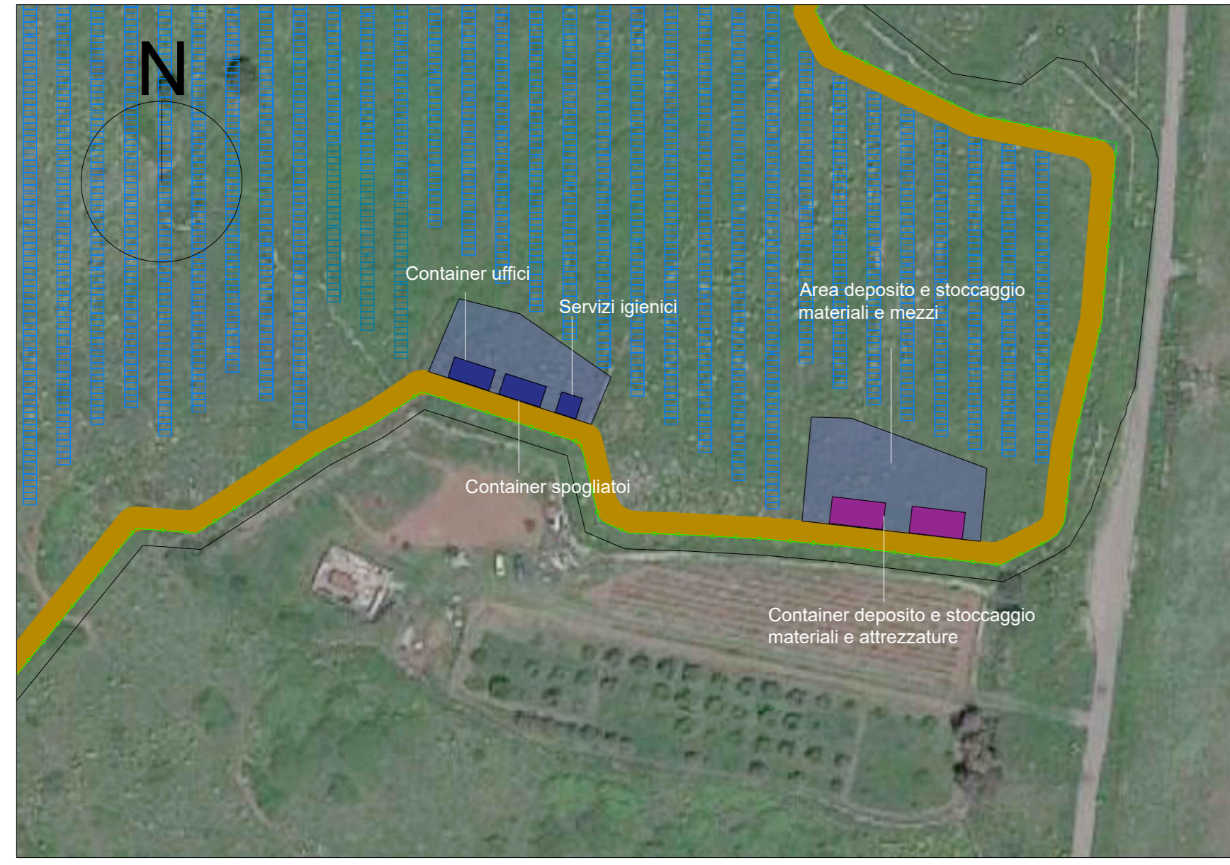
Particolare 1 aree cantiere - Scala 1:1000
