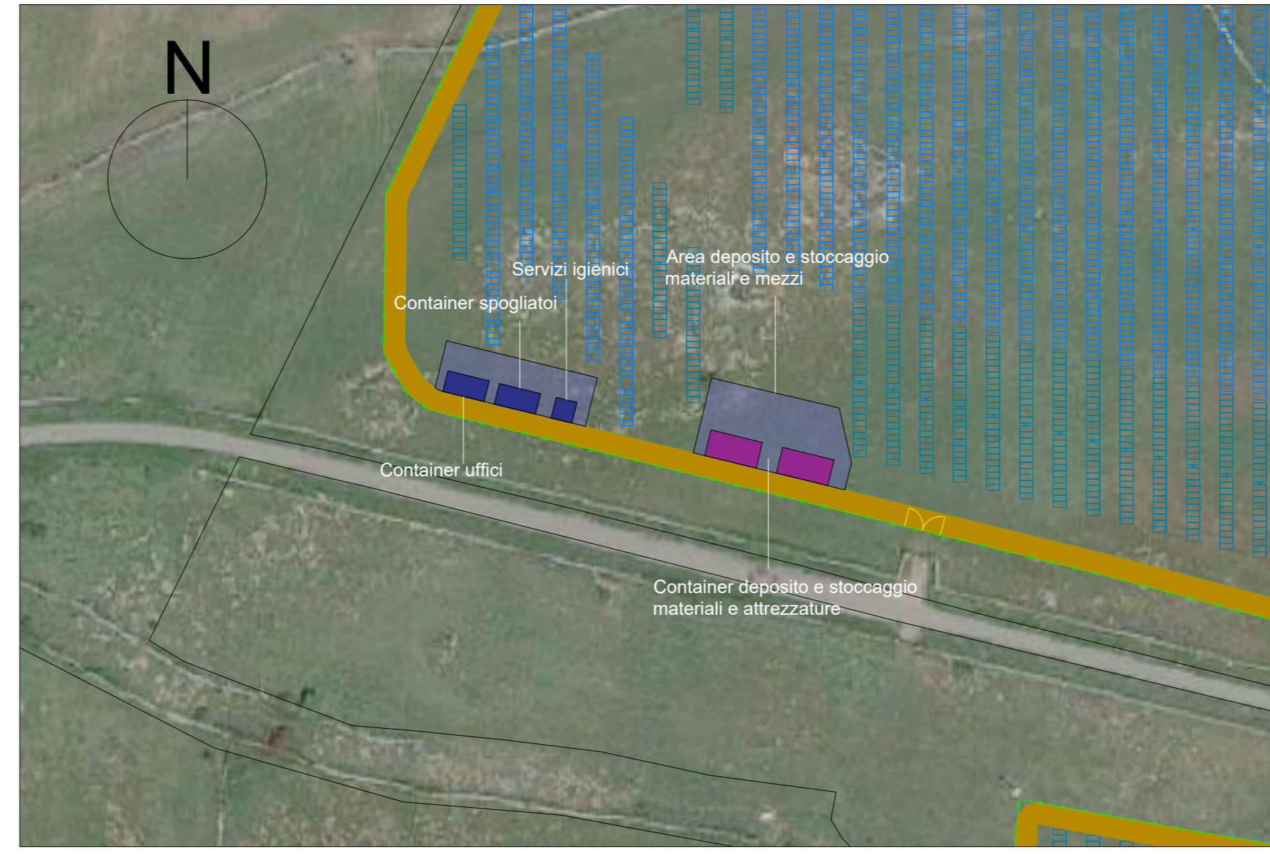
Planimetria aree logistiche di cantiere - Scala 1:4000
