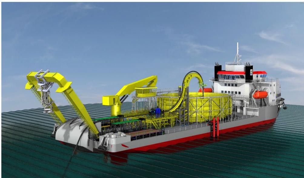
**Figura 3:11: Esempio di nave posa cavo**
