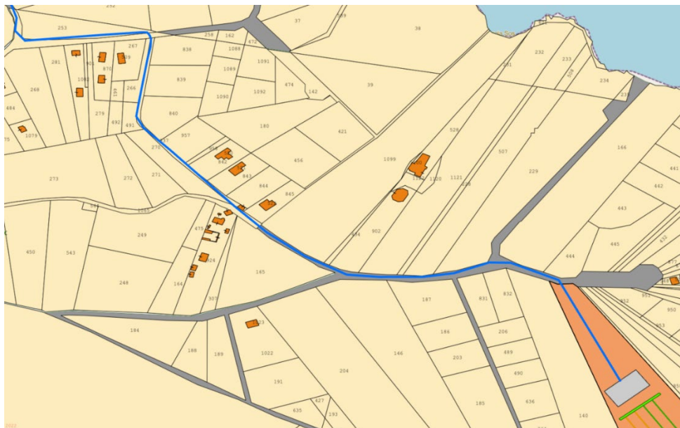
Figura 3:4: Cavidotto AT su catastale – Tratto 1
