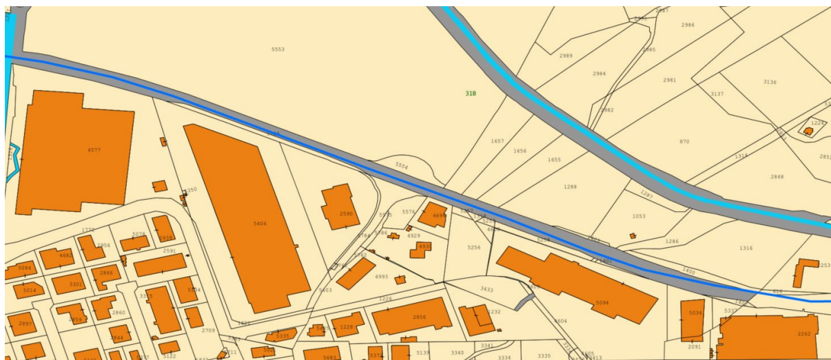
Figura 3:13: Cavidotto AT su catastale – Tratto 10
