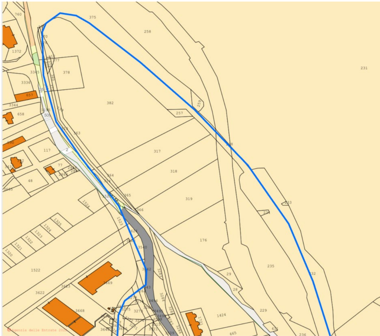
Figura 3:15: Cavidotto AT su catastale – Tratto 12
