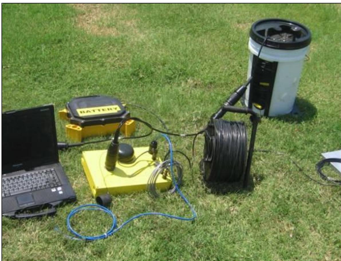
Figura 3.5 – Sismografo DaqLinkIII.
