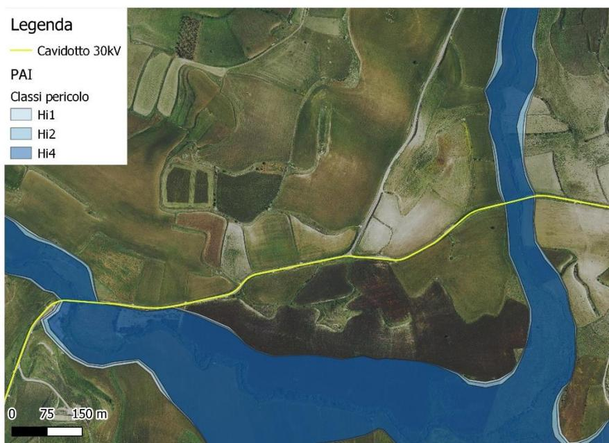
Figura 1.14 – Sovrapposizione del cavidotto MT a 30kV e le aree a pericolosità idraulica Hi4
