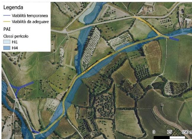
Figura 1.12 – Sovrapposizione tra tratti di viabilità da adeguare e le aree a pericolosità idraulica Hi4
