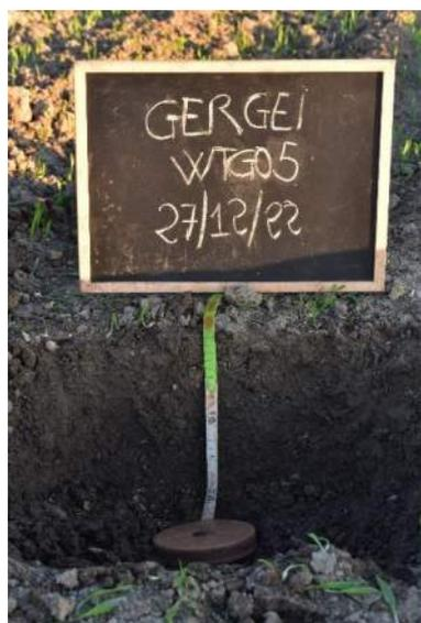
Il sito in cui è prevista la messa in posa dell'aerogeneratore WTG05, ricade nella parte alta di altipiano collinare, a quota di 331m s.l.m. inserito geologicamente come per il precedente, sulle Litofacies nelle Marne di Gesturi (GSTc). L'unità cartografica di appartenenza è l'unità l'ATN e la pendenza rilevata è di circa l'1,5%.
