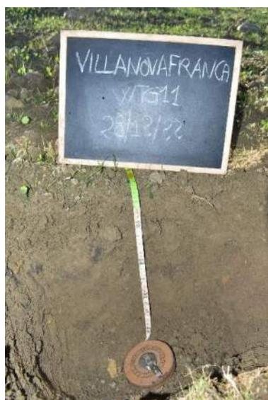
Il sito in cui è prevista l'installazione dell'aerogeneratore WTG11 è ubicato nella parte mediana di un pendio collinare, a quota di 340m s.l.m. ed è inserito geologicamente nella Marne di Gesturi. La morfologia è convessa. L'unità cartografica di appartenenza è l'unità MAN 2. La pendenza rilevata è importante di circa il 22%.
