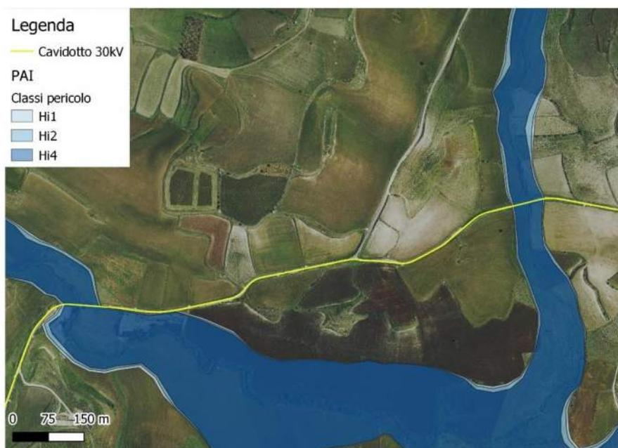
Figura 8.21 – Sovrapposizione del cavidotto MT a 30kV e le aree a pericolosità idraulica Hi4
