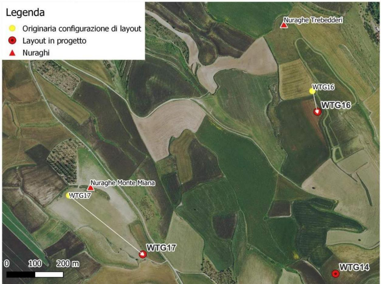
Figura 9.6: Originarie postazioni eoliche WTG16 e WTG17 (in giallo) e riposizionamento finale di progetto (in rosso).
