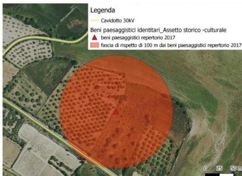
Figura 8.11: Sovrapposizione del Cavidotto MT, ivi impostato su viabilità esistente, con buffer di 100m da bene di valenza storico culturale, così come cartografato dal PPR, in prossimità di "Nuraghe"
