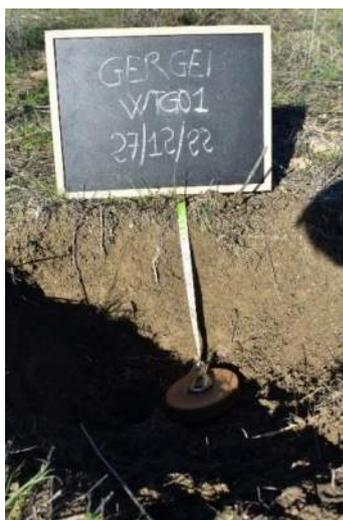
Il sito in cui è prevista l'installazione dell'aerogeneratore WTG01 ricade nella parte alta di una collina, a quota di 292m s.l.m., inserito geologicamente nella Formazione della Marmilla (RML). La micromorfologia è concava, l'unità di terra di appartenenza è la MAN 1 mentre la pendenza rilevata è di circa il 6%.
