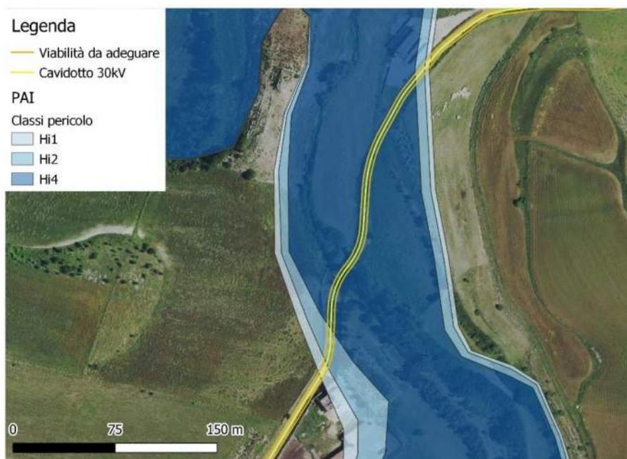
Figura 8.20 – Sovrapposizione di un tratto di viabilità da adeguare e le aree a pericolosità idraulica Hi4
