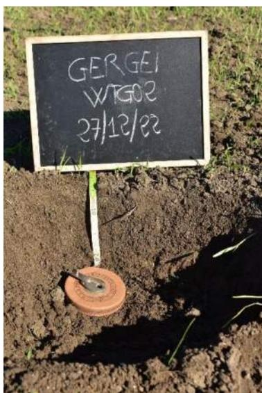
Il sito in cui è prevista la messa in posa dell'aerogeneratore WTG02 è posto nella parte alta di una collina e ricade parzialmente sulle coltri eluvio-colluviali a quota di 321m s.l.m. La stazione è compresa tra due unità di terra distinte la DCO 1 e la MAN 1, la micromorfologia è concava mentre la pendenza rilevata è del 7%.
