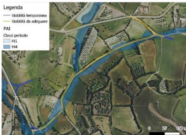
Figura 8.19 – Sovrapposizione tra tratti di viabilità da adeguare e le aree a pericolosità idraulica Hi4
