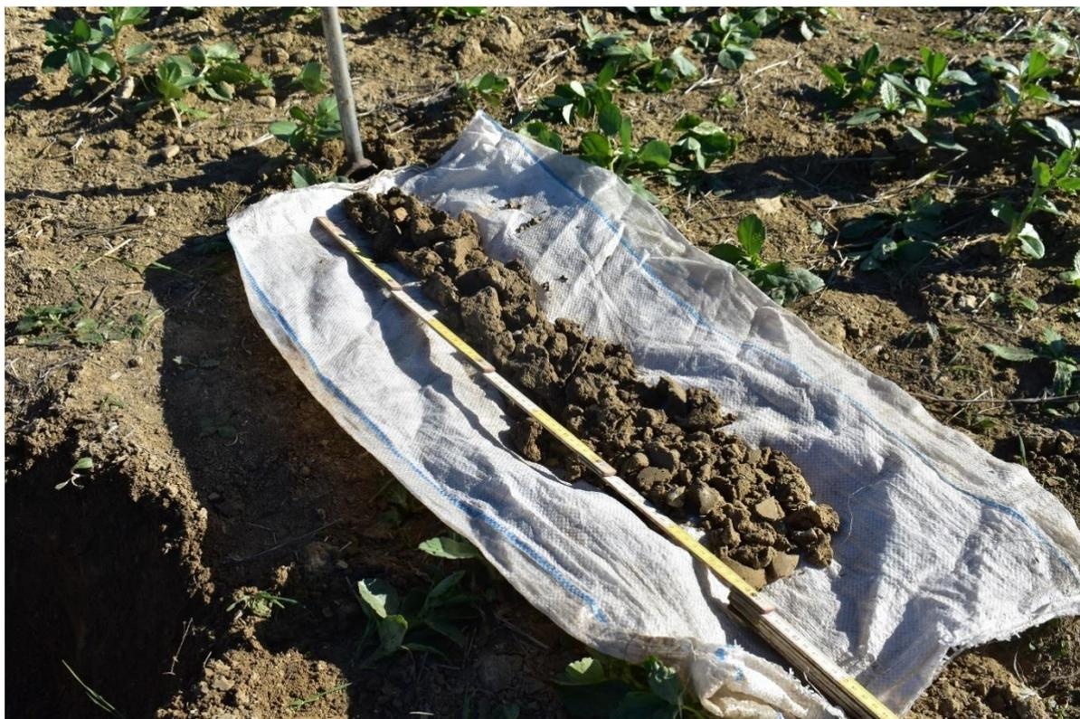
*Figura 18 - Trivellata nella stazione WTG4 effettuata a partire da 25cm*
