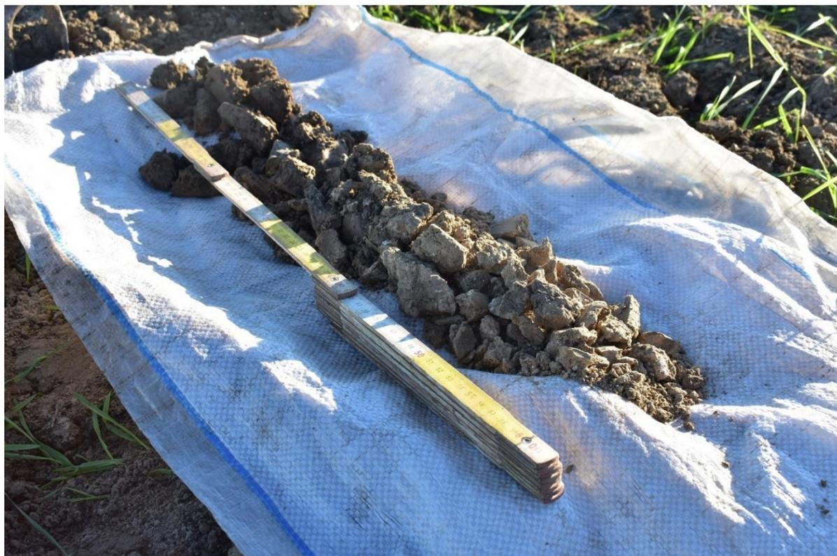
Figura 61 - Trivellata nella stazione WTG13 effettuata a partire da 25cm
