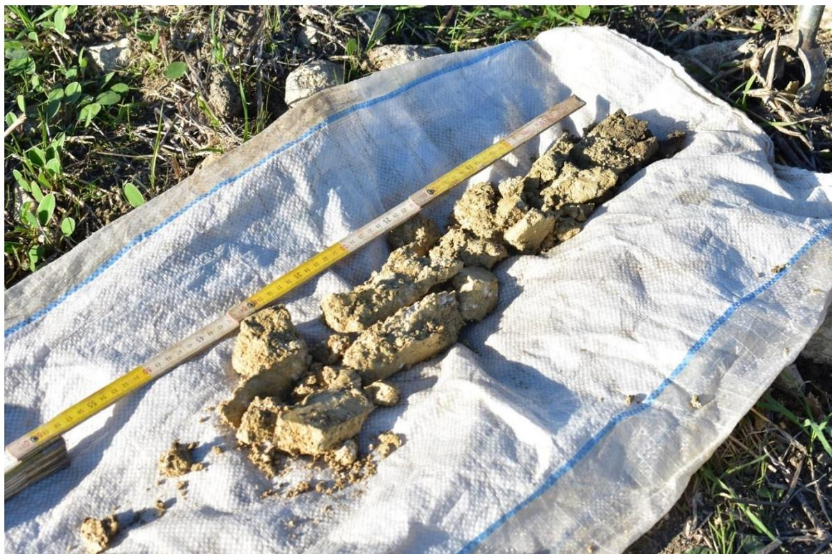
*Figura 28 - Trivellata nella stazione WTG06 effettuata a partire da 35cm*
