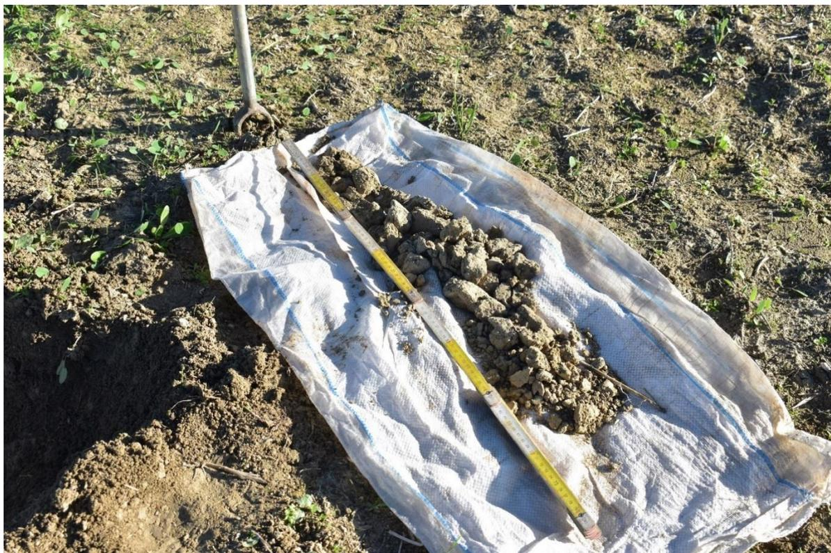
*Figura 13 - Trivellata nella stazione WTG03 effettuata a partire da 20cm*
