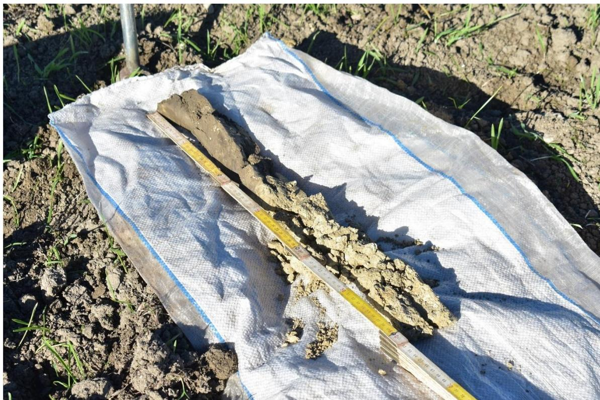
*Figura 34 - Trivellata nella stazione WTG07 effettuata a partire da 30cm*
