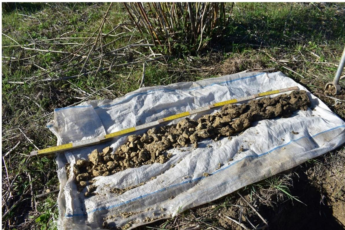
*Figura 3 – Trivellata nella stazione WTG01 effettuata a partire da 30cm*
