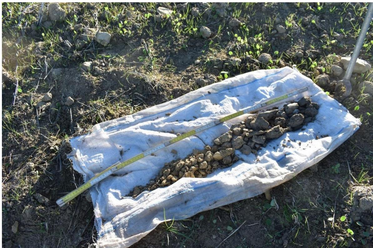
*Figura 53 - Trivellata nella stazione WTG11 effettuata a partire da 40cm*
