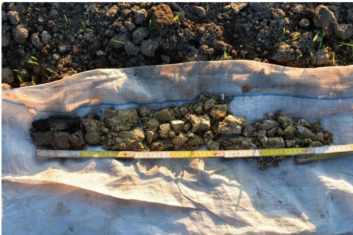
*Figura 23 - Trivellata nella stazione WTG05 effettuata a partire da 25cm*
