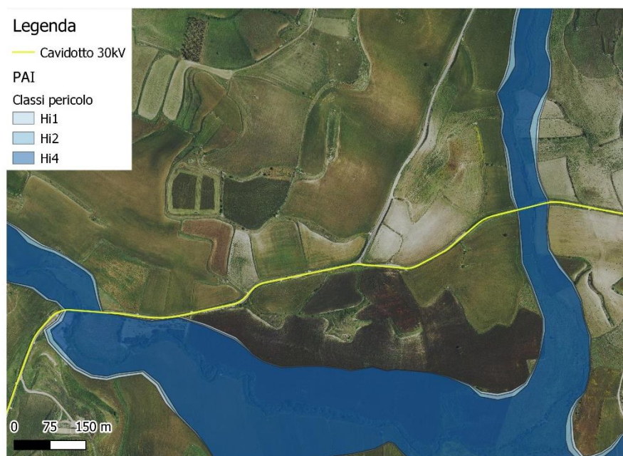
Figura 4.8 – Sovrapposizione del cavidotto MT a 30kV e le aree a pericolosità idraulica Hi4
