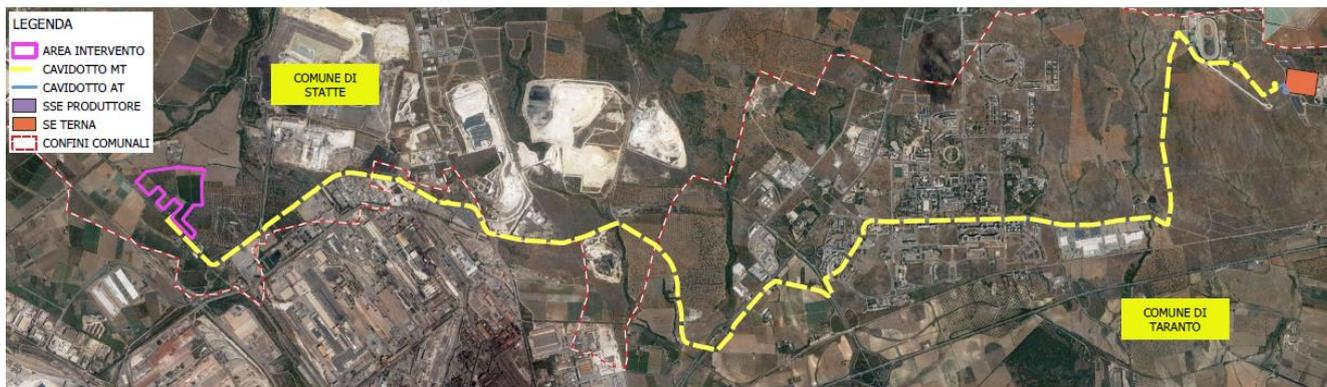
**Figura 4-3: Inquadramento territoriale su Ortofoto del complesso del percorso del cavidotto di connessione MT (in giallo)**
