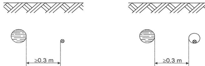
Incroci e parallelismi tra cavi di energia in tubazione e tubazioni di gas con densità non superiore a 0,8 non drenate con pressione massima di esercizio >5 Bar
