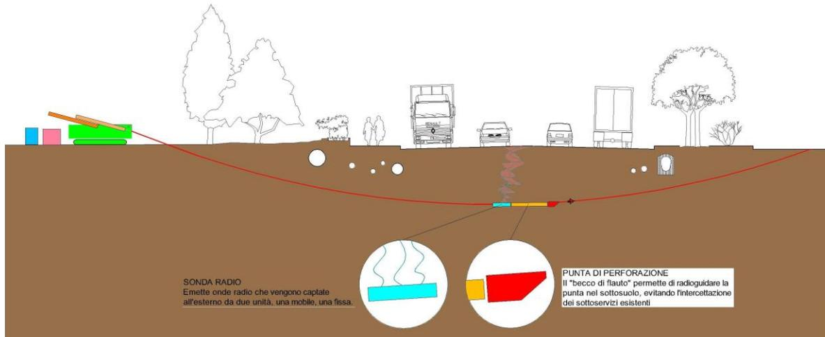
fase 1: REALIZZAZIONE FORO PILOTA CON CONTROLLO ALTIMETRICO
