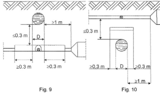
I manufatti di protezione e gli elementi separatori in calcestruzzo armato sono da considerarsi strutture non metalliche. Come manufatto di protezione di singole strutture con sezione circolare possono essere utilizzati collari di materiale isolante fissati ad esse.
