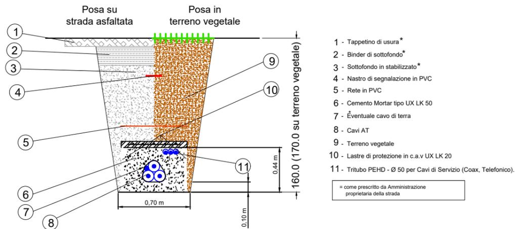
SEZIONE TIPICA VIA CAVO SU STRADE STERRATE
