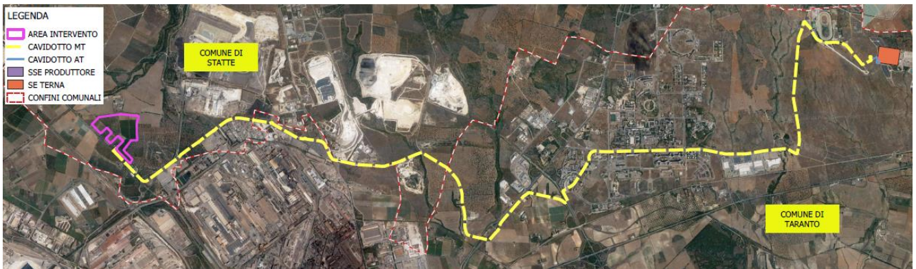
Figura 2-3: Inquadramento territoriale su Ortofoto del complesso del percorso del cavidotto di connessione MT (in giallo)
