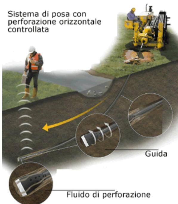
**Figure 5-Sistema di trivellazione orizzontale controllata (T.O.C.).**
