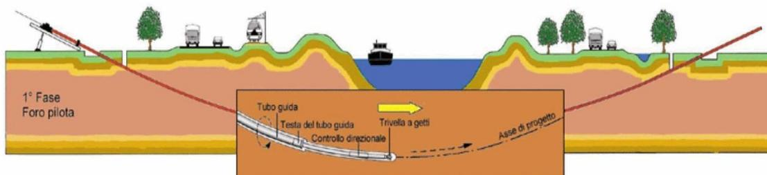
**Figure 6 – Schema della fase di realizzazione del foro pilota.**
