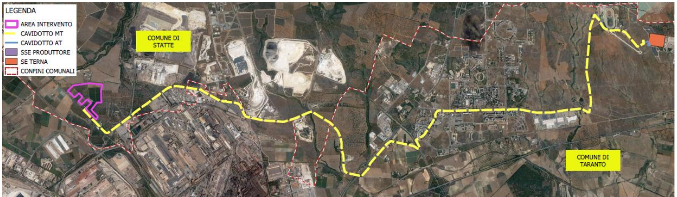
Figura 1-4: Inquadramento territoriale su Ortofoto del complesso del percorso del cavidotto di connessione MT (in giallo)
