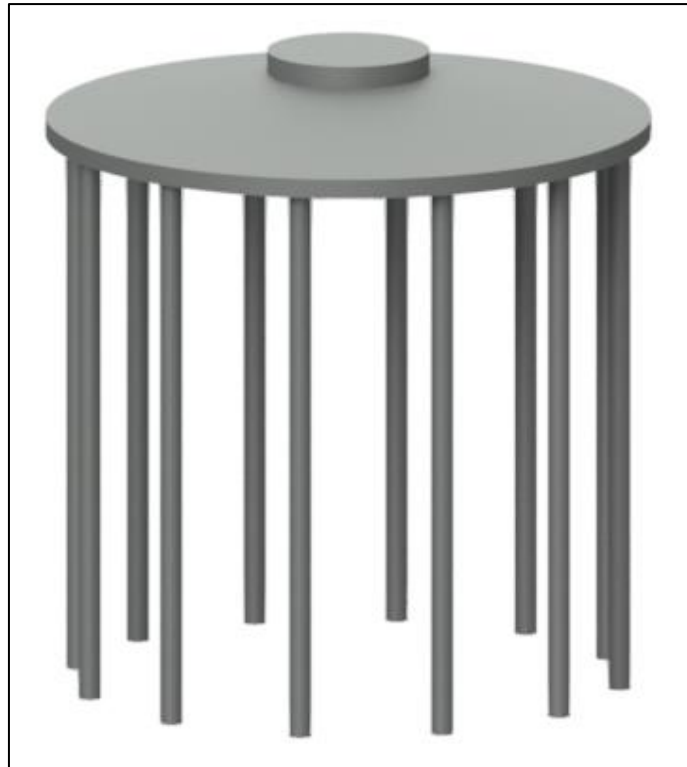
Figura 3: vista tridimensionale della fondazione dell'aerogeneratore
