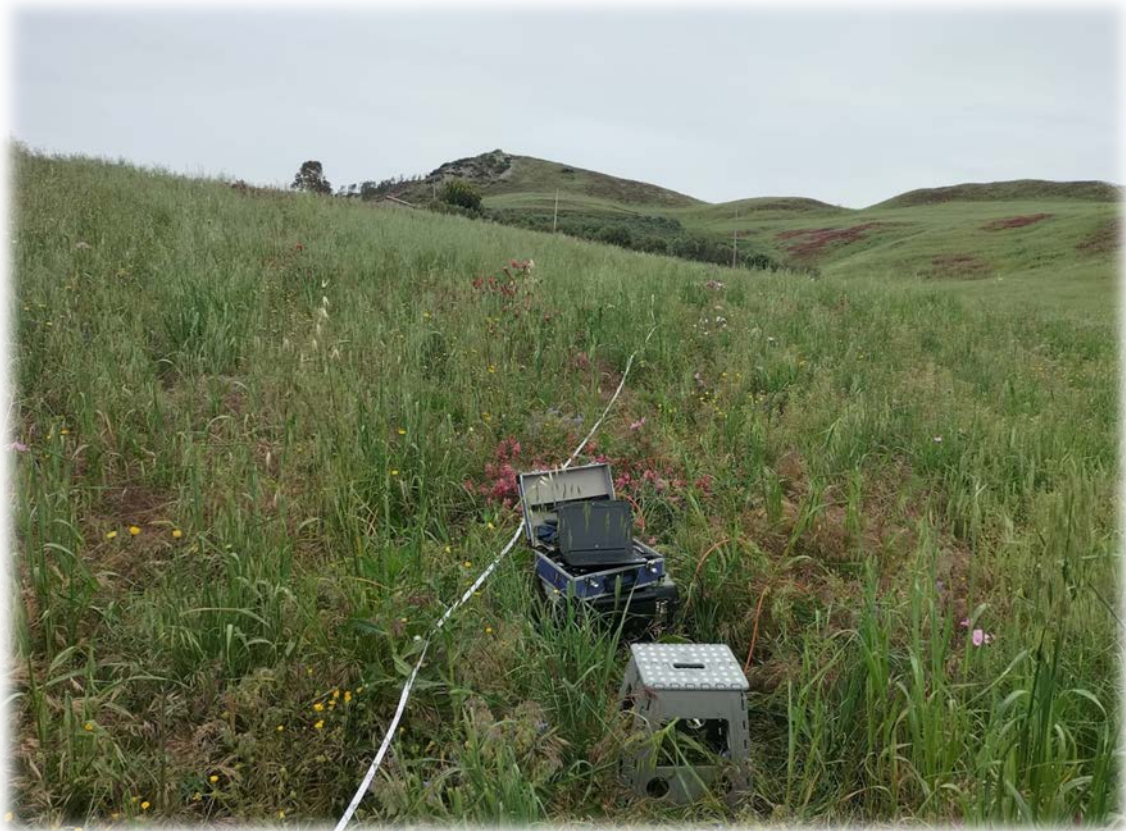
Stendimento sismico di tipo MASW_T1
