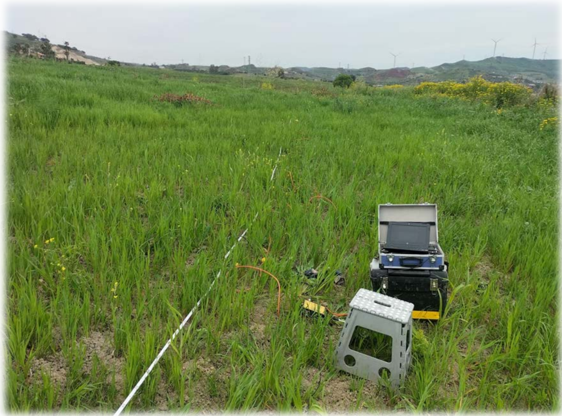
Stendimento sismico di tipo MASW_SE
