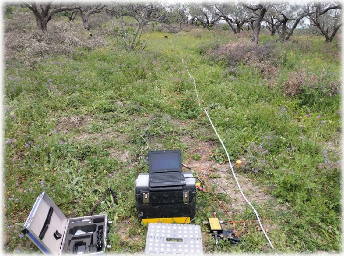
Stendimento sismico di tipo MASW_T6
